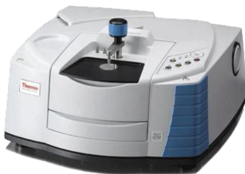
Εικόνα 3.5: Φασματόμετρο Υπέρυθρου Μετασχηματισμού Fourier (FTIR), Nicolet 6700 thermoscientific, με Αποσβένουσα Ολική Ανάκλαση (ATR).
