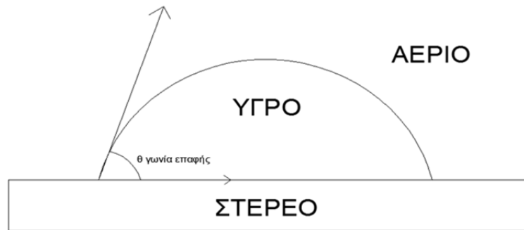
Σχήμα 5: Σταγόνα υγρού η οποία επικάθεται σε επιφάνεια στερεού. Ορισμός γωνίας διαβροχής.
