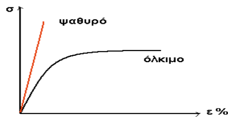
Διάγραμμα 5.1: Διάγραμμα τάσης-παραμόρφωσης ψαθυρού και όλκιμου υλικού.
