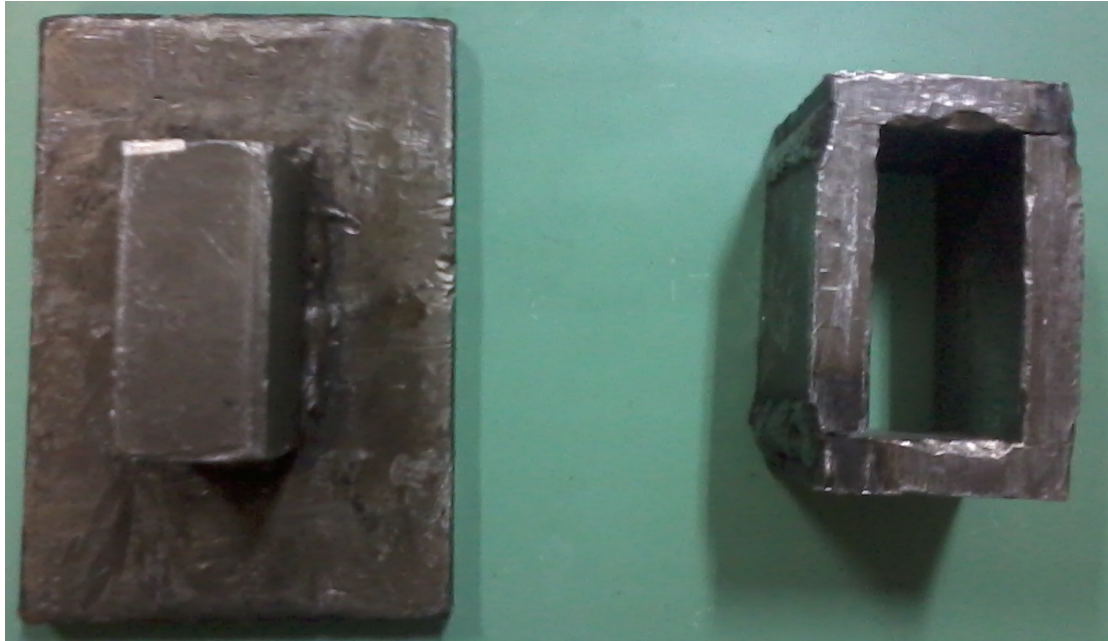
Εικόνα 5.4: Μεταλλικό καλούπι ορθογώνιας διατομής.
