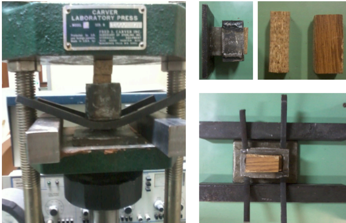
Εικόνα 5.6: Διάταξη για την αφαίρεση του υλικού από το καλούπι.
