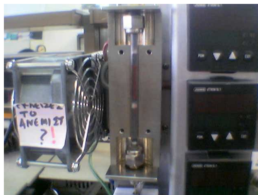
Σχήμα 5.3: Μπλόκ εκρόφησης-υποδοχής δειγμάτων εκπνεόμενου αέρα (TDU).
