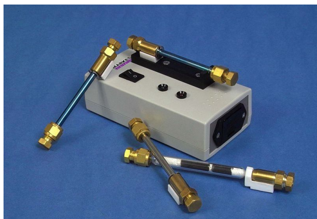
Σχήμα 3.4: Διαφορετικά είδη προσροφητικών παγίδων (μεταλλικές, υάλινες) με πώματα ασφαλείας.
