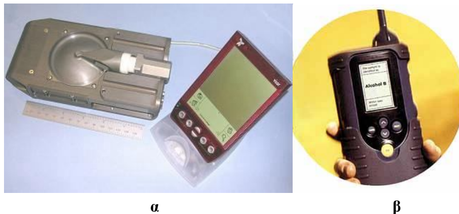
Σχήμα 3.10: α.Συστοιχία 32 αισθητήρων αερίων της εταιρίας JPL (e-Nose) και β.Συστοιχία 32 αισθητήρων αερίων (Cyranose-320)
