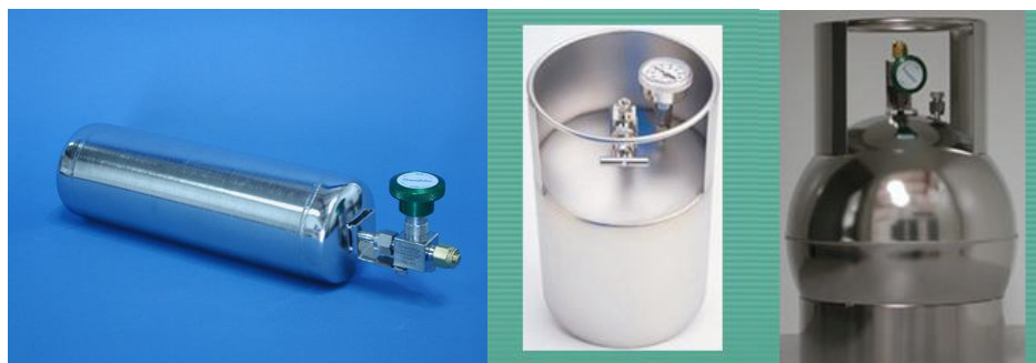
Σχήμα 3.1: Μεταλλικά δοχεία διαφορετικών όγκων συλλογής αέρα (1 L, 3 L, SUMMA 2 L)
