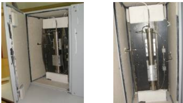
Εικόνα 3.1.5. Ο φούρνος της σταθερής κλίνης στο σύστημα αναλυτή πίσσών
