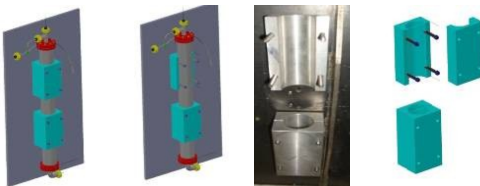
Εικόνα 3.1.6. Σχεδιασμός μηχανισμού τοποθέτησης των μεταλλικών εξαρτημάτων στήριξης της κλίνης
