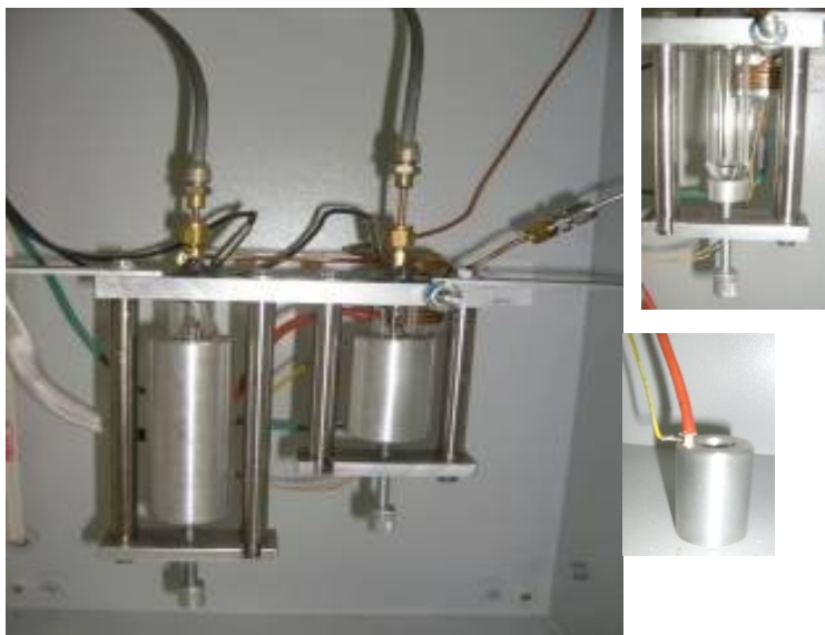
Εικόνα 3.1.2. Το σύστημα τροφοδοσίας για την εισαγωγή των πρισών μέσω των θερμαινόμενων δοχείων
