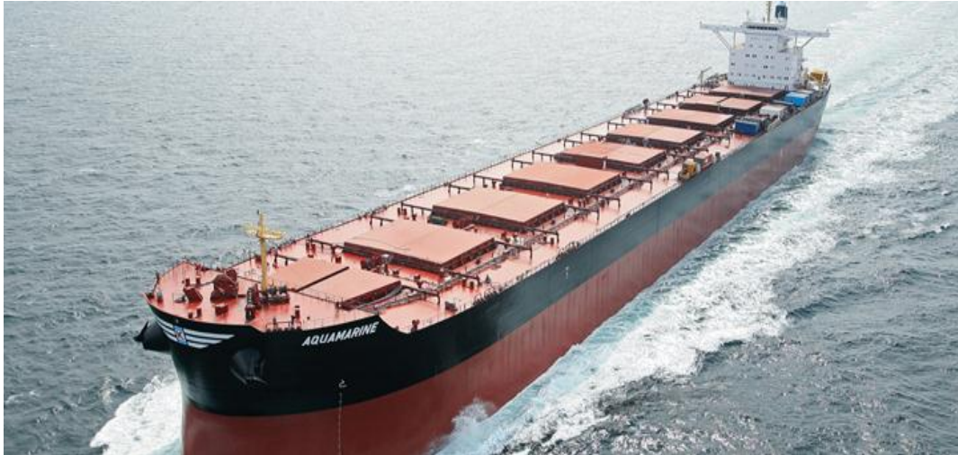
Εικόνα 2.1: Capesize Bulk Carrier, 180000tons DWT, “Aquamarine”, Odense Maritime
