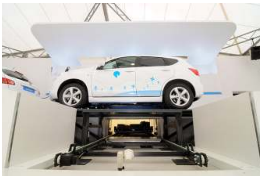
Εικόνα 2.4.2.2: Επίδειξη του αυτοματοποιημένου συστήματος ανταλλαγής συσσωρευτών της εταιρίας Better Place [38]
