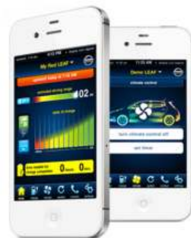
Εικόνα 2.2.4: Εφαρμογή για smart phones, που ενημερώνει τον ιδιοκτήτη ηλεκτρικού οχήματος “Nissan Leaf” για τις σημαντικότερες παραμέτρους του οχήματός του [35]
