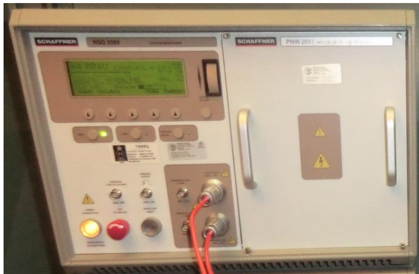
ΣΧΗΜΑ Γ-18: Γεννήτρια PNW 2051 και κεντρική μονάδα NSG 2050 [37]
