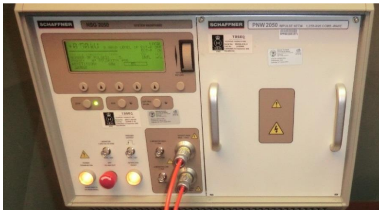
ΣΧΗΜΑ Γ-12: Γεννήτρια κρουστικών παλμών PNW 2050 και κεντρική μονάδα NSG 2050 [36]
