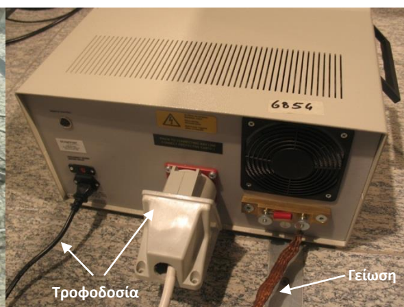
ΣΧΗΜΑ 4-22 α) Εμπρόσθια όψη του δικτύματος του τεχνητού ηλεκτρικού δικτύου (LISN) [44]
