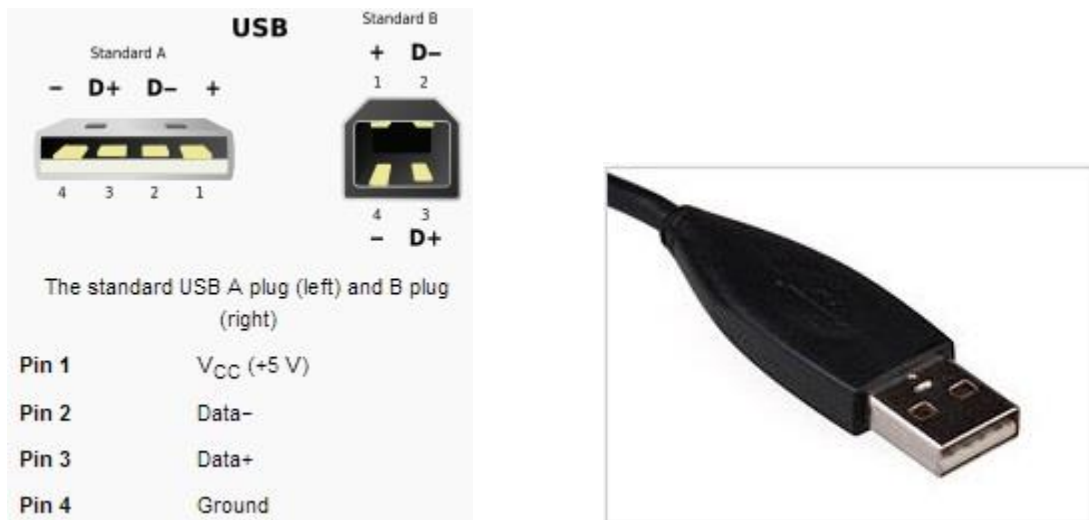
ΣΧΗΜΑ 2-17: Τυπικά παραδείγματα USB 2.0 θύρας και καλωδίου [54]
