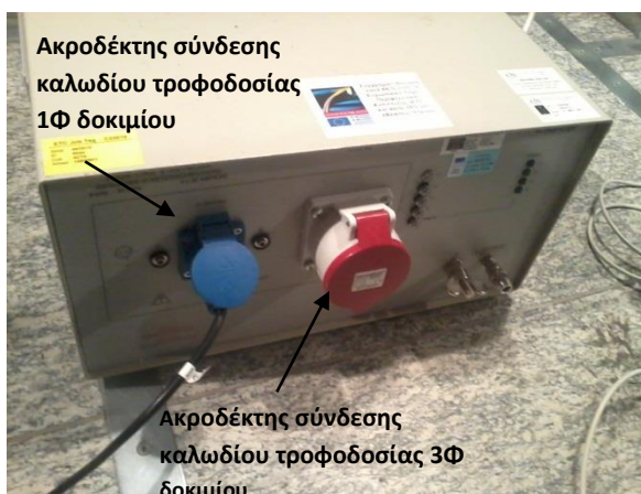
ΣΧΗΜΑ 4-22 α) Εμπρόσθια όψη του δικτύματος του τεχνητού ηλεκτρικού δικτύου (LISN) [44]
