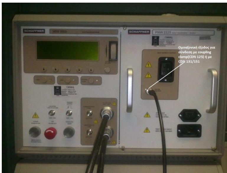
ΣΧΗΜΑ Γ-3: Γεννήτρια παρασίτων PNW 2225 και κεντρική μονάδα NSG 2050 [33]
