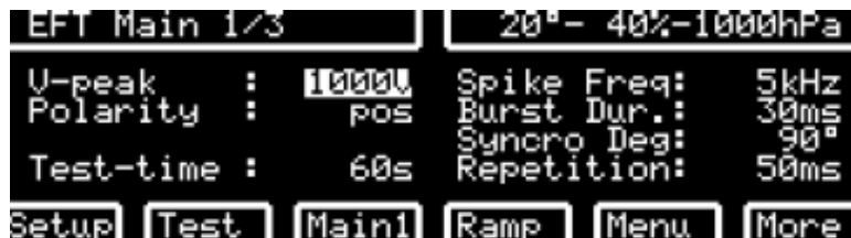
ΣΧΗΜΑ Γ-38: Επιλογή “Sychro Deg.” στην οθόνη ρύθμισης παραμέτρων για τη δοκιμή EFT [34]
