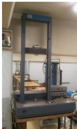
Εικόνα 2.2: Το όργανο μέτρησης θλιπτικής αντοχής Instron 1026
