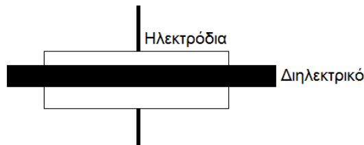
Εικόνα 11: Δημιουργία πυκνωτή από το δοκίμιο και δύο μεταλλικά ηλεκτρόδια – τεχνική DRS.
