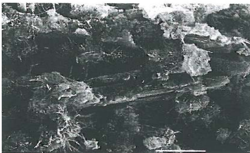
Σχήμα 20. Λεπτές βελόνες πρωτογενούς ετρινγκίτη σε τσιμέντο μικρής ηλικίας. Κρύσταλλος Ca(OH)_2 αποτίθεται σε κυψελίδες στην επιφάνεια των κόκκων του τσιμέντου
