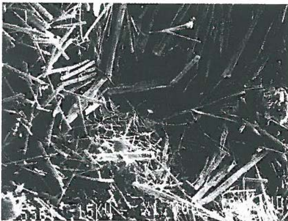
Σχήμα 21. Εξάπλωση επανακρυσταλλωμένου δευτερογενούς ετρινγκίτη, μέσα σε πορώδες του μπετόν, ως αποτέλεσμα επίθεσης θεικών
