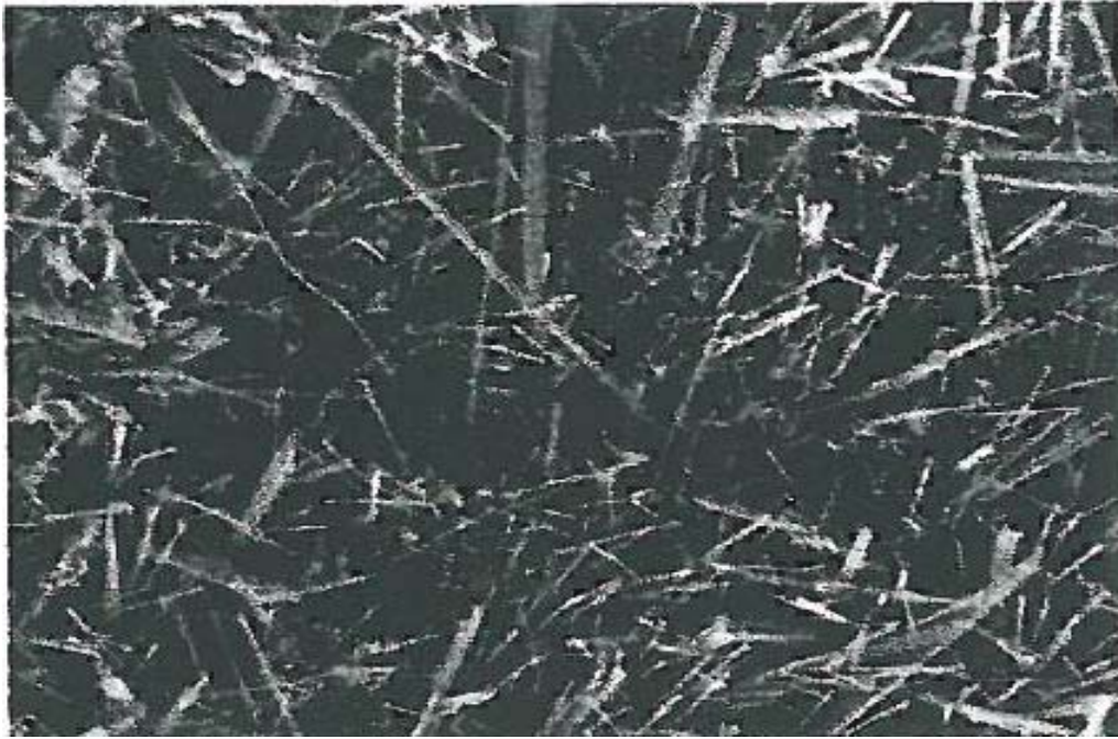
Σχήμα 23. Περίβλημα δευτερογενούς ετρινγκίτη μη διογκωτικού χαρακτήρα σε αποτύπωμα κόκκου. Επανακρυστάλλωση κατά την πυρόλυση των κόκκων/πάστας.
