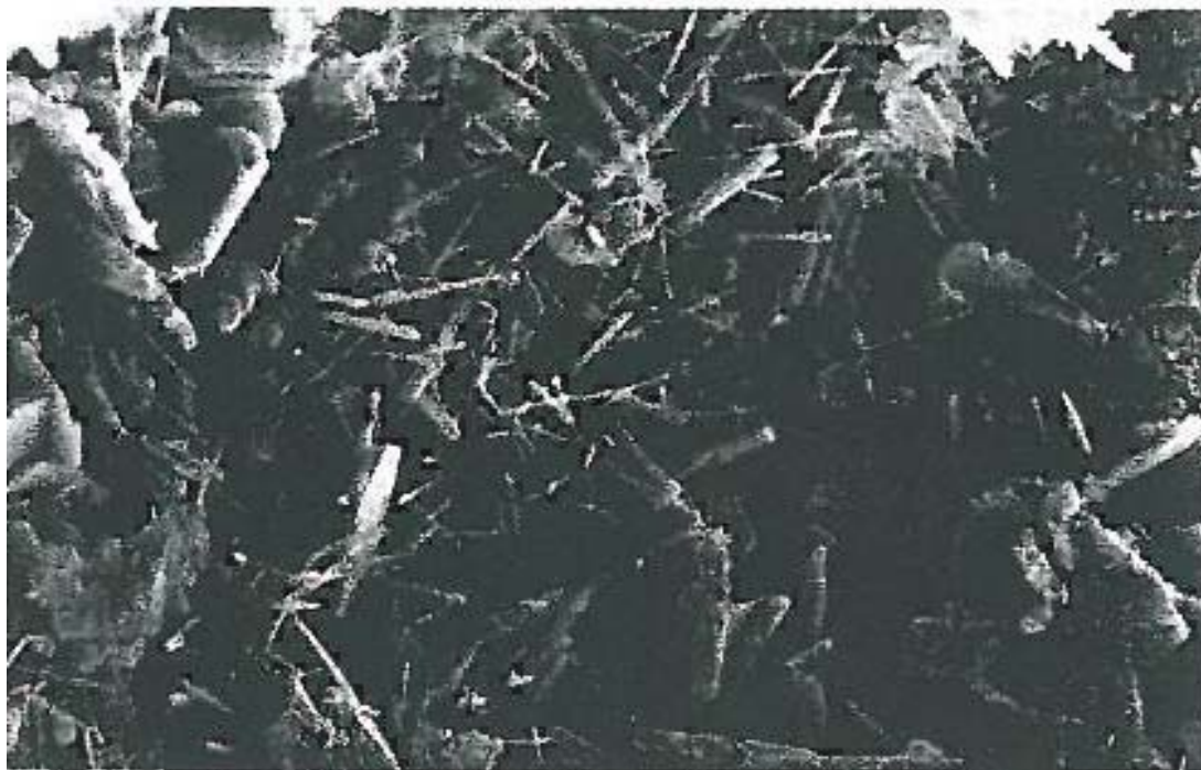
Σχήμα 29. Βελόνες ετρινγκίτη και εξαγωνικές πλακέτες χλωροαργιλικού ασβεστίου μέσα σε μπετόν που βρίσκεται σε θαλάσσιο περιβάλλον.
