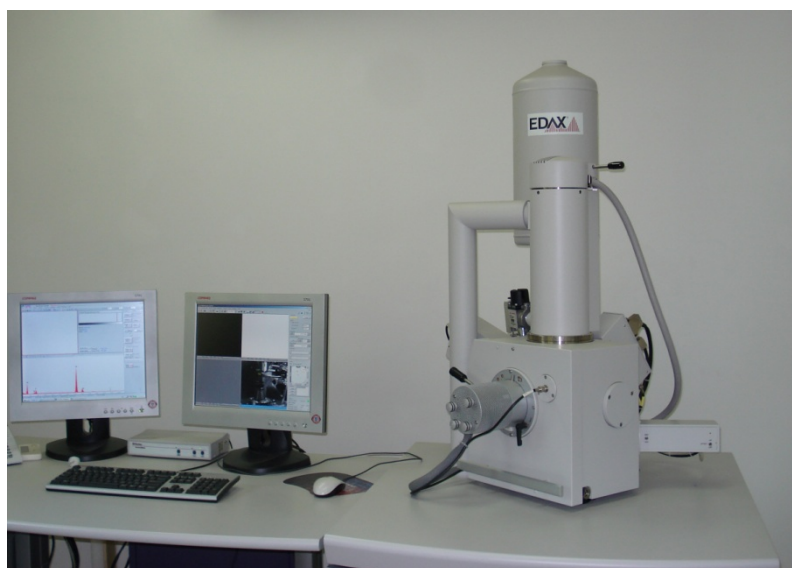
Σχήμα 4.4. Μικροσκόπιο SEM (FEI QUANTA 200) με προσαρμοσμένο σύστημα EDS.
