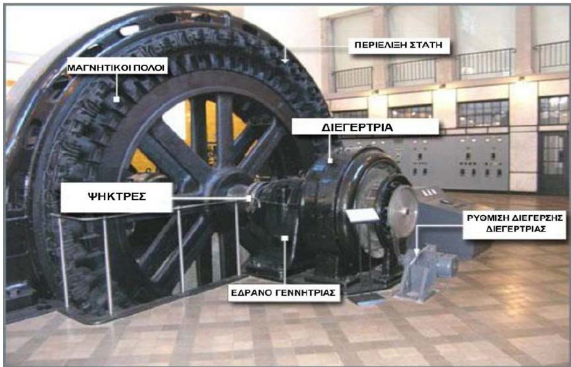
Σχήμα 3.1: Σύγχρονη γεννήτρια εναλλασσόμενου ρεύματος
