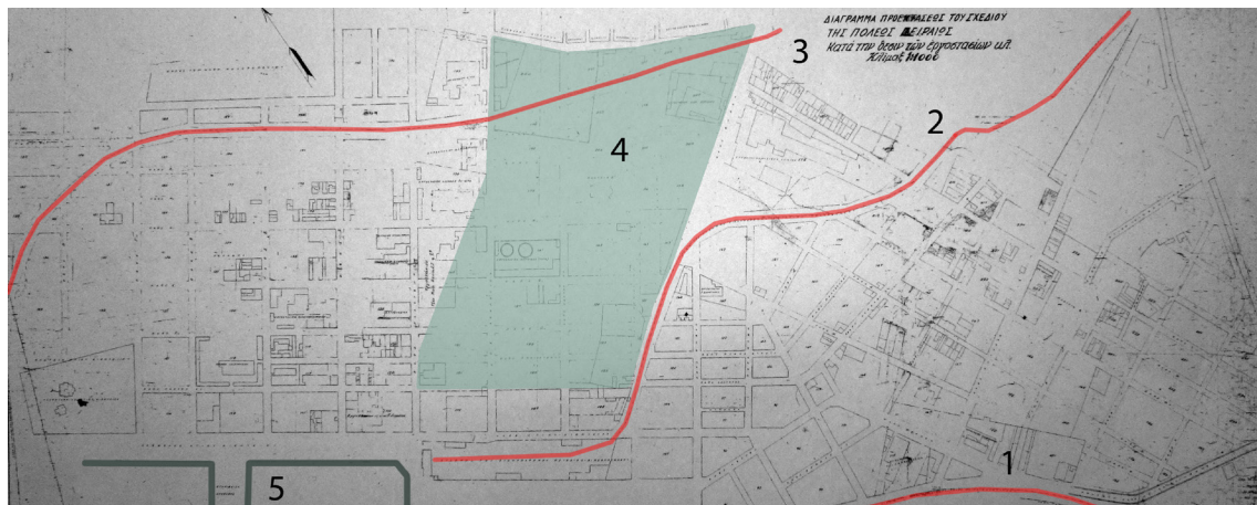
Εικόνα 19: Το ρυμοτομικό της περιοχής των εργοστασίων του 1892. Εδώ βλέπουμε τη σιδ/κή γραμμή Πειραιώς-Αθηνών (1), τη σιδ/κή γραμμή Πειραιώς-Πελοποννήσου (2), τη σιδ/κή γραμμή Πειραιώς-Συνόρων (3), την πρώην περιοχή των «κηποπέδων» (4) και τη διαμόρφωση των κρηπιδωμάτων στο λιμένα Αλών (5).
