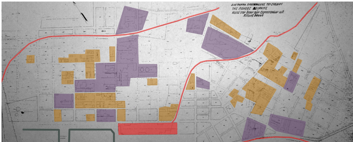
Εικόνα 20: Ίδιο σχέδιο με την εικόνα 19. Εδώ υπάρχει και αποτύπωση εργοστασίων με το όνομα του ιδιοκτήτη τους (μύβ περιοχές), κτισμάτων χωρίς κάποια περιγραφή (κίτρινες περιοχές) και του σταθμού Πελοποννήσου (κόκκινη περιοχή).
