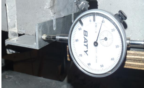
Σχήμα 3-11: Τα βελόμετρα τοποθετημένα στο δοκίμιο
