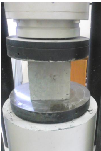
Σχήμα 3-6: Δοκιμή θλίψης κυβικού δοκιμίου
