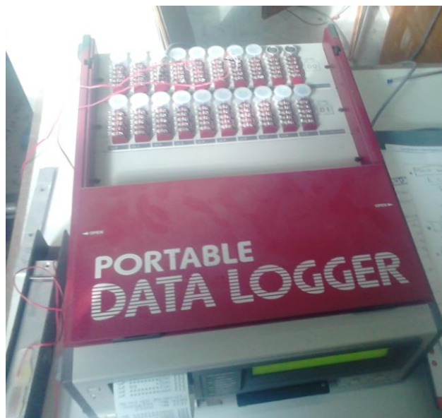
Σχήμα 3-10: Σύστημα καταγραφής μετρήσεων των ηλεκτρομηκυσιομέτρων
