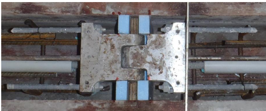
Σχήμα 3-3: Η μεταλλική άρθρωση της δοκού-δοκιμίου
