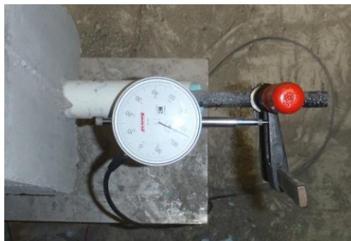
Σχήμα 3-12: Τα βελόμετρα τοποθετημένα στο δοκίμιο
