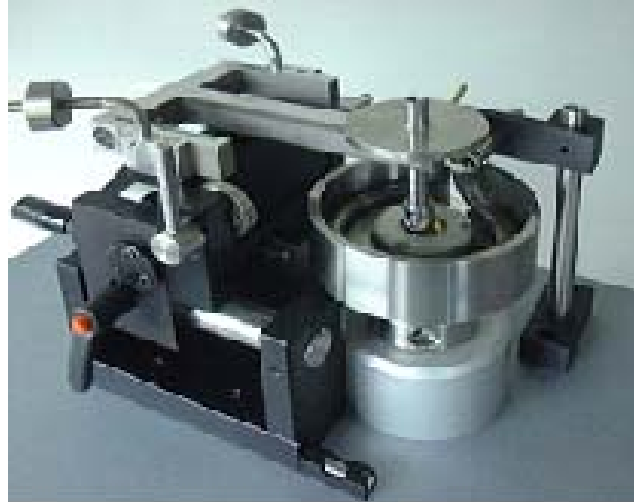
Σχήμα 5.3-01 Τυπική συσκευή ακίδας πάνω σε δίσκο, ανάλογη με αυτήν που χρησιμοποιήσαμε .
