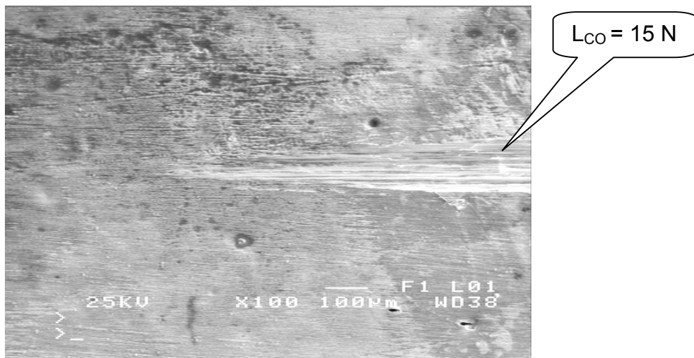
Σχήμα 6.2.1-04 Το τμήμα του ίχνους χάραξης, όπου ασκήθηκε το κρίσιμο φορτίο συνοχής( L_{CO} ), για το δοκίμιο του χαλκού με επίστρωμα κράματος Ni-W, με περιεκτικότητα σε W περίπου 50 % wt, που είχε αποτεθεί με πυκνότητα ρεύματος i = 70 \text{ mA/cm}^2 , σε θερμοκρασία T = 50 \text{ }^\circ\text{C} και χρόνο t = 60 \text{ min} .
