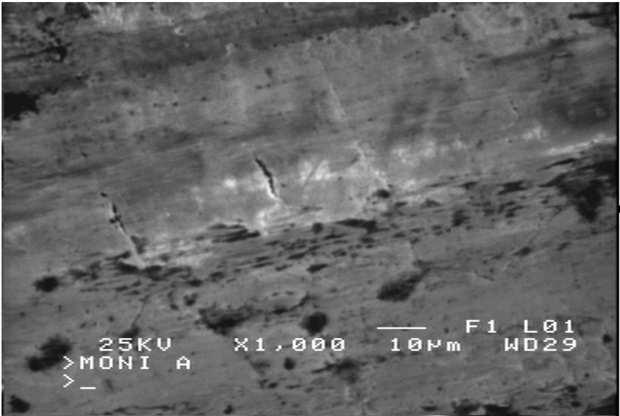
Σχήμα 6.3-05 Μικρογραφία Ηλεκτρονικού Μικροσκοπίου Σάρωσης για το επίστρωμα Ni-W, μετά από διαβρωτική τριβή σε διάλυμα NaCl 1 M, με ανταγωνιστικό υλικό ανοξειδωτο μαρτενσιτικό χάλυβα. Το φορτίο ήταν 200 g, η ταχύτητα 30 cm/s και το μήκος διαδρομής περίπου 300 m, πείραμα p-146-we-200-30-300.
