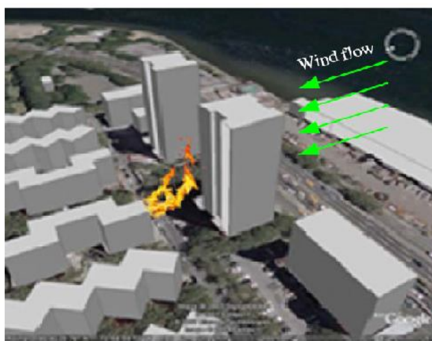
Σχήμα 2.9 Συμπεριφορά της φωτιάς πίσω από ένα ψηλό κτίριο σε πλευρικό άνεμο (Zhibin Chen et al., 2009).
