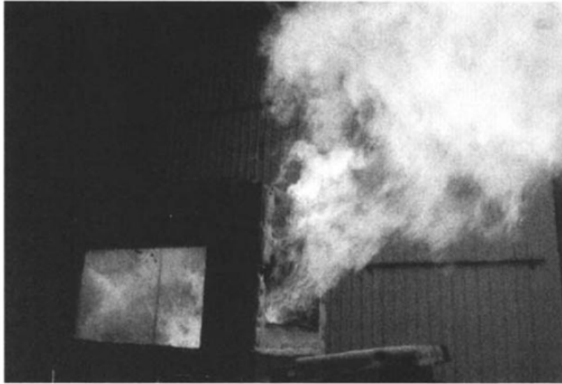
Σχήμα 1.17 Μετάβαση από το στάδιο ανάπτυξης της φωτιάς στο στάδιο της καθολικής ανάφλεξης εκτός του διαμερίσματος (Drysdale et al., 1999).
