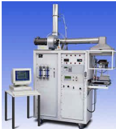
Σχήμα 1.2 Όργανο μέτρησης του ρυθμού έκλυσης θερμότητας - Διάταξη Θερμιδόμετρου τύπου Κώνου.
