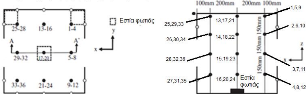
Σχήμα 4.98 Κάτοψη σε τομή A-A' και πλάγια όψη του διαμερίσματος.
