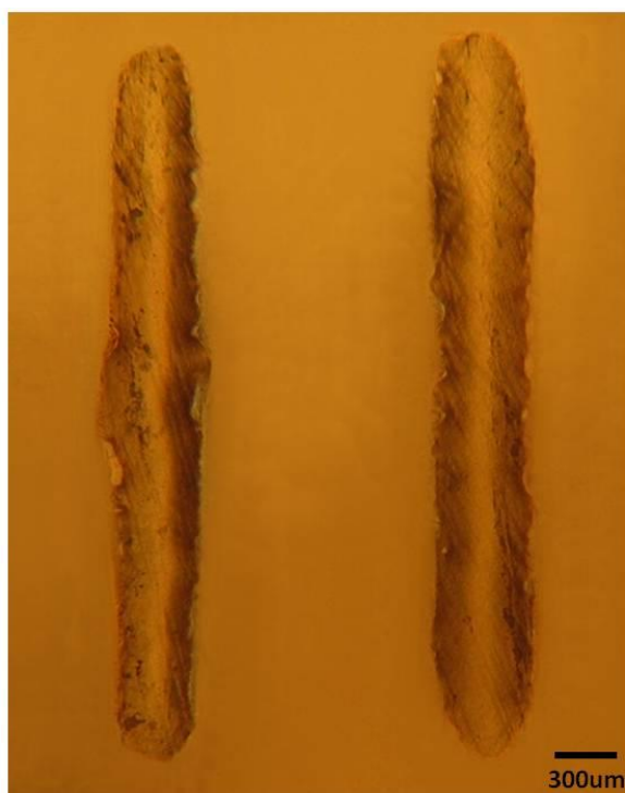
Εικόνα 5.12 Φωτογραφία οπτικού μικροσκοπίου που απεικονίζει δύο γραμμές του διαλύματος NMP/γραφενίου, πάχους 280-300μm, εκτυπωμένες με LIFT πάνω σε PEN.
