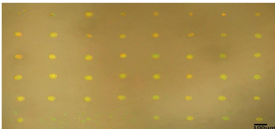
Εικόνα 5.7 Φωτογραφία από οπτικό μικροσκόπιο που απεικονίζει ένα πίνακα 8x6 αποτελούμενο από εκτυπωμένες με LIFT σταγόνες σε υπόστρωμα Si/SiO 2 (πάχος οξειδίου 1μm). Κάθε γραμμή αντιστοιχεί σε διαφορετική πυκνότητα ενέργειας.
