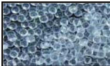
Εικ. 3.28: Δομή αφρώδους γυαλιού.
