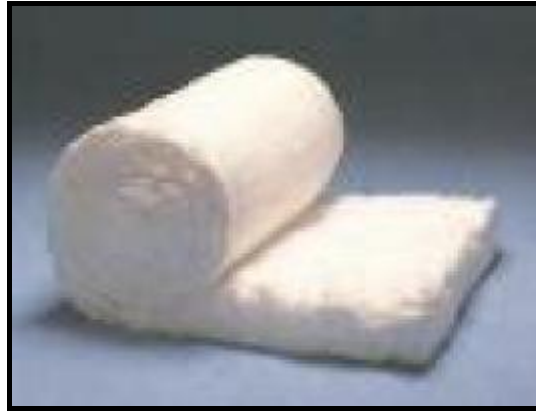
Εικ. 3.4: Πάπλωμα υαλοβάμβακα με μεταλλικό πλέγμα.
