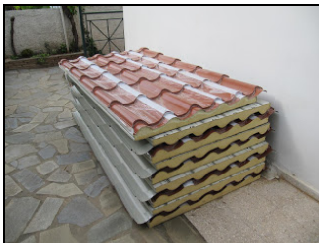
Εικ. 3.23: Προκατασκευασμένες πλάκες πολυουρεθάνης με μεταλλικά φύλλα κυματοειδούς μορφής.
