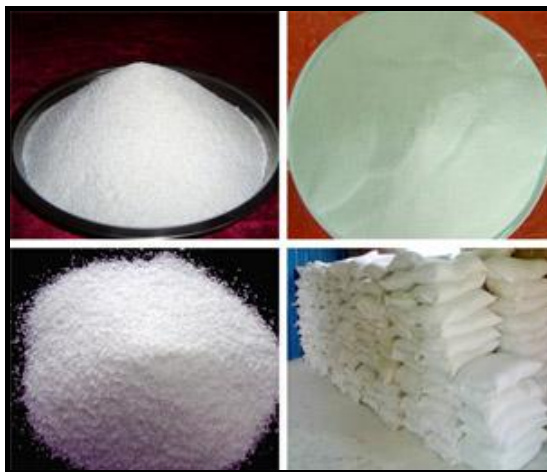
Εικ. 3.33: Κόκκοι περλίτη και περλίτης σε σάκους.
