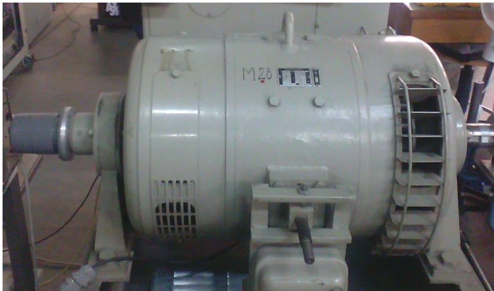
Σχ. 5.3 Κινητήρια DC μηχανή ξένης διέγερσης για τον έλεγχο της ταχύτητας
