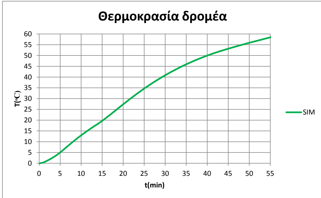
Σχ. 3.7 Κατανομή θερμοκρασίας του δρομέα για t_{\text{simulation}} = 55 \text{ min}
