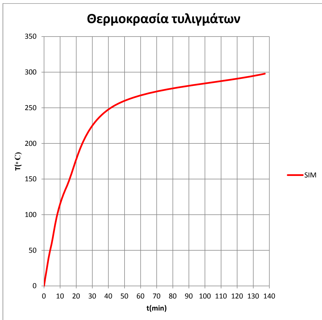
Σχ. 3.4 Κατανομή θερμοκρασίας των τυλιγμάτων του στάτη
