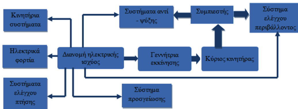
Σχ. 1.10 Σύστημα διανομής ισχύος σύμφωνα με την ιδέα More Electric Aircraft, [4].
