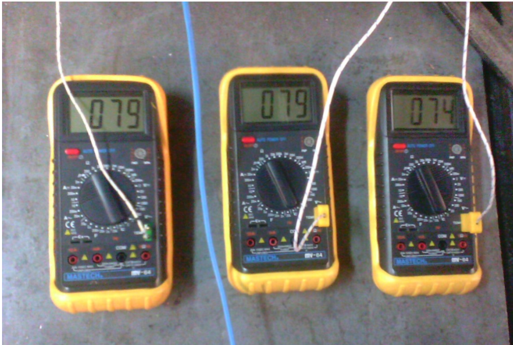
Σχ. 5.5 Πολύμετρα για την καταγραφή των θερμοκρασιών
