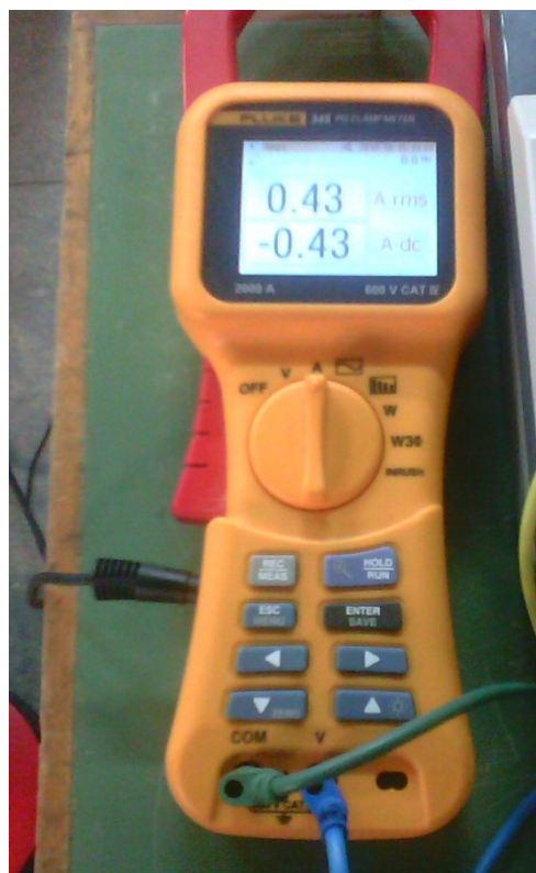
Σχ. 5.6 Διάταξη για τη μέτρηση του ρεύματος τυλιγμάτων της σύγχρονης μηχανής
