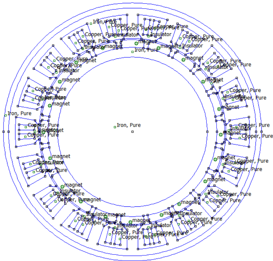
Σχ. 4.1 Τομή κάθετη στον άξονα του κινητήρα
