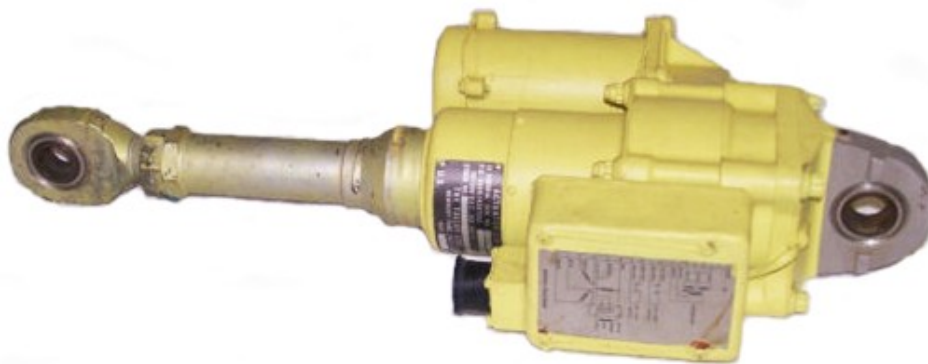
Σχ. 1.1 Γραμμικός ηλεκτρομηχανικός σερβοκινητήρας του αεροσκάφους F – 4, [24].
