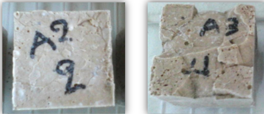
Σχήμα 6.5: Δοκίμια μετά τον τρίτο κύκλο δοκιμών ψύξης-απόψυξης
