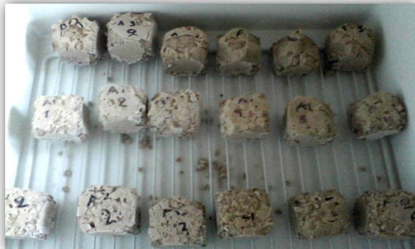
Σχήμα 6.6: Δοκίμια μετά τον 6 ο κύκλο ψύξης-απόψυξης Από πάνω προς τα κάτω: A3, A1, A2
