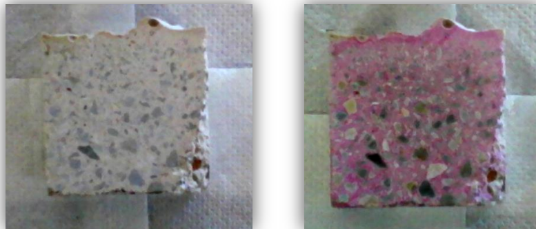
Σχήμα 6.21: Δοκίμιο A3 πριν και μετά τη δοκιμή ελέγχου ενανθράκωσης με φαινολοφθαλεΐνη
