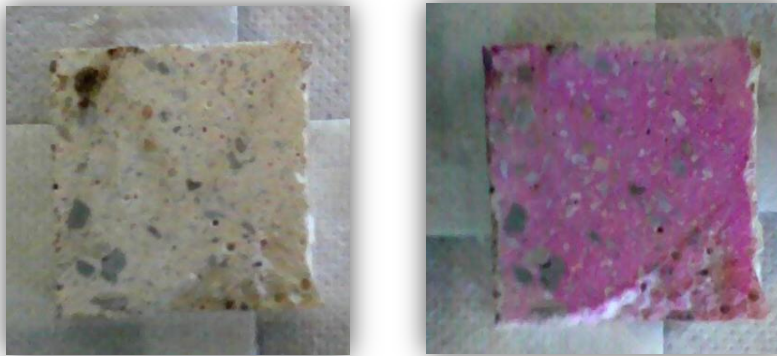
Σχήμα 6.20: Δοκίμιο A2 πριν και μετά τη δοκιμή ελέγχου ενανθράκωσης με φαινολοφθαλεΐνη
