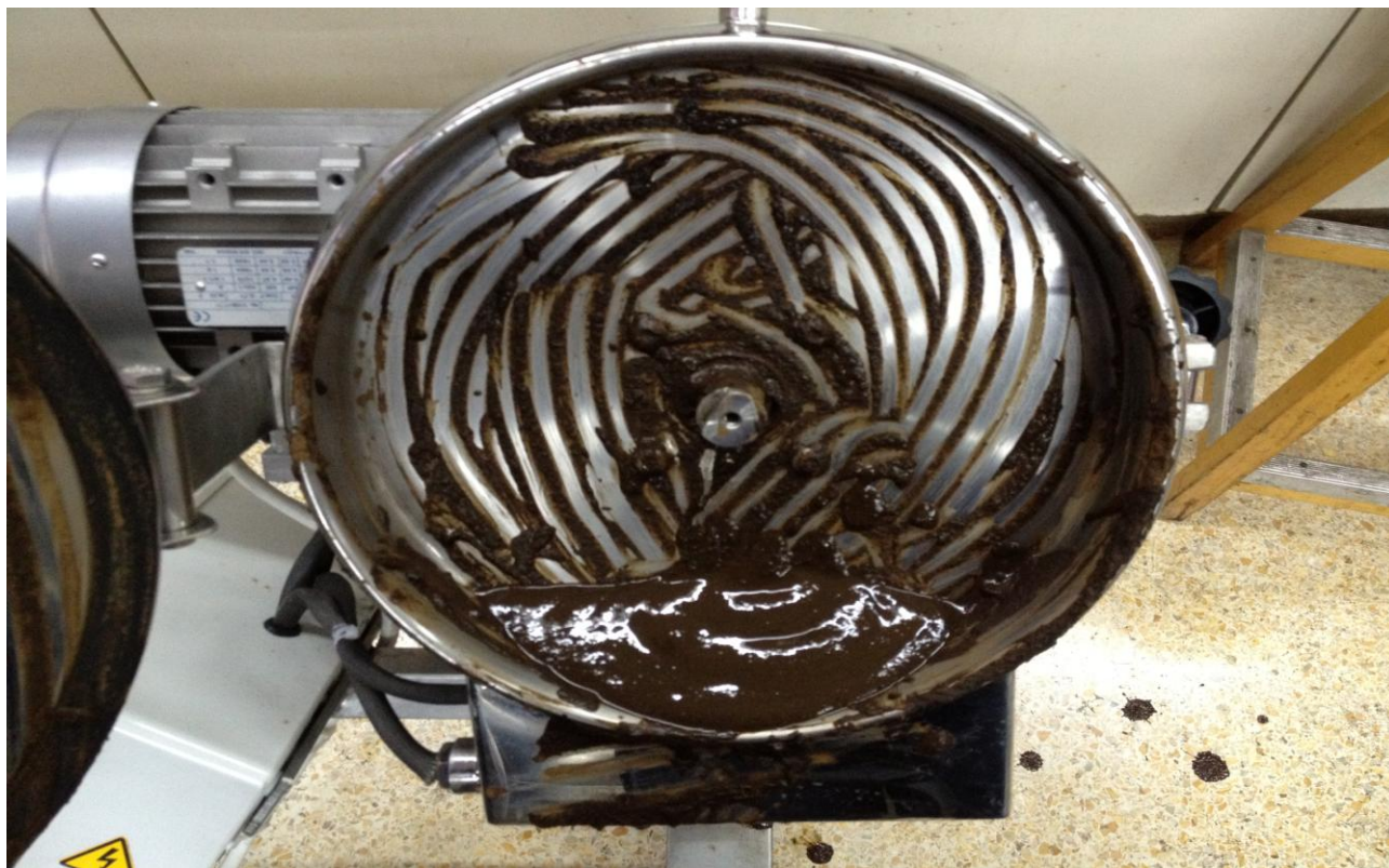
Εικόνα 13: Προϋδρόλυση με 23%DM στους 50 0 C με 7 FPU ενζύμων
