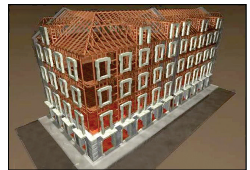
Κατασκευαστικό σύστημα της gaiola πηγή: Federico Sanches
