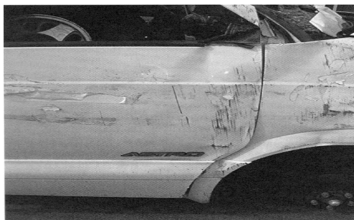
Σχήμα 5.18 Απεικόνιση τμήματος του δεξιά μπροστά φτερού και της πόρτας όπου φαίνεται η οριοθέτηση μεταξύ τμημάτων της λαμαρίνας που υπέστησαν φθορά και αυτών που δεν υπέστησαν
