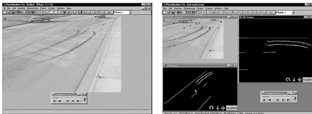
Σχήμα 9.3 Παράδειγμα αποτύπωσης ιχνών από φωτογραφίες
