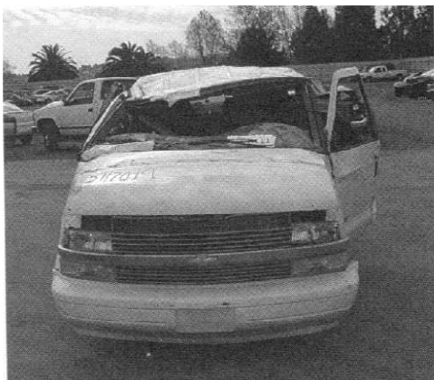
Σχήμα 5.16 Αριστερά: Παραμόρφωση της πλευράς του συνοδηγού από την πρώτη ανατροπή Δεξιά: Παραμόρφωση του πλαινού τμήματος του οχήματος
