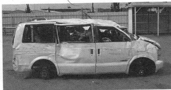
Σχήμα 5.16 Αριστερά: Παραμόρφωση της πλευράς του συνοδηγού από την πρώτη ανατροπή Δεξιά: Παραμόρφωση του πλαινού τμήματος του οχήματος
