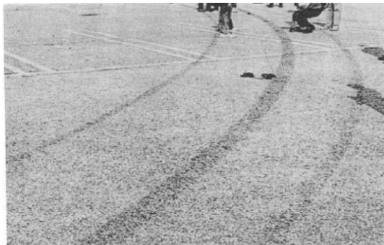
Σχήμα 4.1 Σημάδια απο ελαστικά που δημιουργήθηκαν πειραματικά από όχημα μάρκας Ford (μοντέλο Taurus) με αρχική ταχύτητα 83.7 km/h
