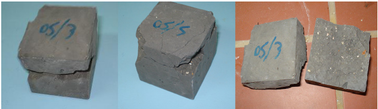
Σχήμα 6-17: Φωτογραφίες δοκιμίων της σύνθεσης FA-0.5 στο τέλος του 1 ου κύκλου ψύξης – απόψυξης
