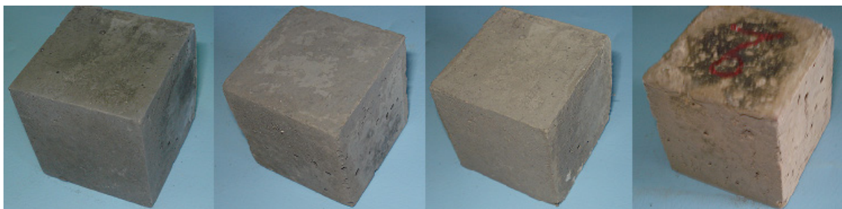
Σχήμα 6-70: Φωτογραφίες γεωπολυμερικών κονιαμάτων της σύνθεσης FA-0.5 πριν (ref) και μετά από έκθεση σε διάφορες θερμοκρασίες
