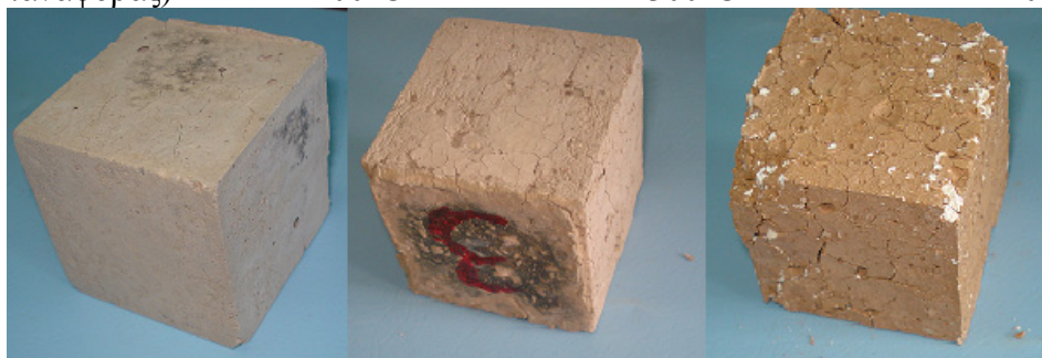
Σχήμα 6-71: Φωτογραφίες γεωπολυμερικών κονιαμάτων της σύνθεσης FA-1 πριν (ref) και μετά από έκθεση σε διάφορες θερμοκρασίες
