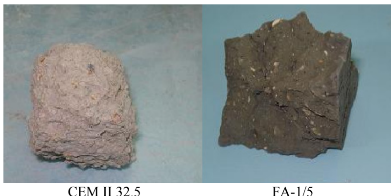
Σχήμα 6-21: Φωτογραφίες δοκιμίων μετά τη συμπλήρωση 21 κύκλων ψύξης – απόψυξης
