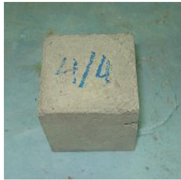
Σχήμα 6-22: Δοκίμιο της σύνθεσης CEM I 42.5 μετά τη συμπλήρωση 42 κύκλων
