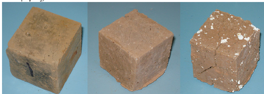
Σχήμα 6-70: Φωτογραφίες γεωπολυμερικών κονιαμάτων της σύνθεσης FA-0.5 πριν (ref) και μετά από έκθεση σε διάφορες θερμοκρασίες
