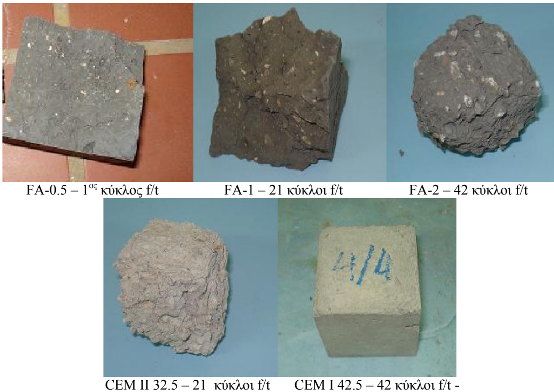
Σχήμα 6-19: Χαρακτηριστικά φθοράς των δοκιμίων όλων των συνθέσεων μετά από διάφορους κύκλους ψύξης – απόψυξης
