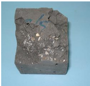
Σχήμα 6-20: Φθορά του δοκιμίου FA-1/5 μετά τη συμπλήρωση 17 κύκλων ψύξης - απόψυξης
