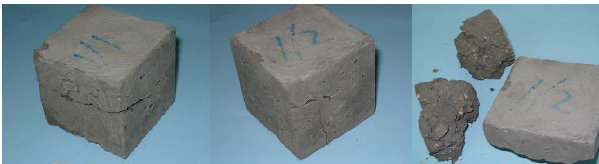
Σχήμα 6-18: Φωτογραφίες δοκιμίων της σύνθεσης FA-1 μετά από διάφορους κύκλους ψύξης – απόψυξης
