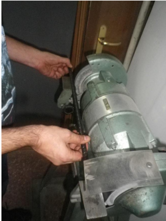
Σχήμα 4.5 Διαδικασία επιφανειακής λείανσης
