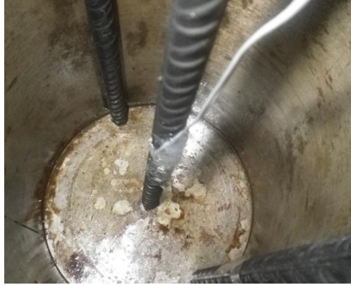
Σχήμα 4.7 συνδεδεμένη με καλώδια και μονωμένη ράβδος
