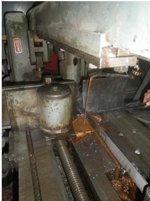
Σχήμα 4.4 Κοπή οπλισμού στο κατάλληλο μήκος
