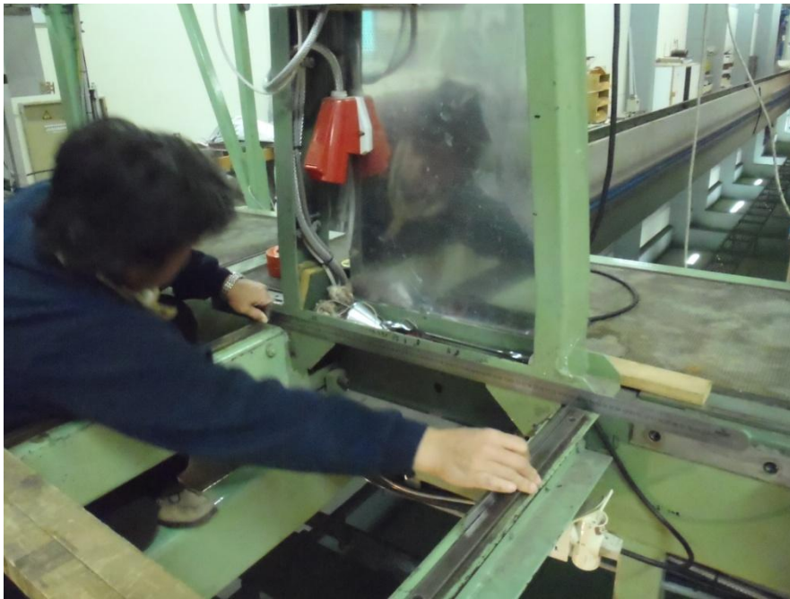
Σχ. 6-5 Τοποθέτηση μεταλλικού χάρακα και εύρεση μέσου, για την μέτρηση της πλευρικής απόκλισης
