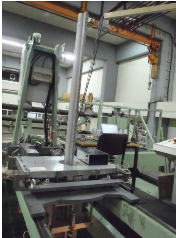
Σχ. 6-4 Το πόδι του δυναμόμετρο και η άκαμπτη πλάκα στήριξης του κυρίως σώματος του δυναμομέτρου πάνω στο φορείο.
