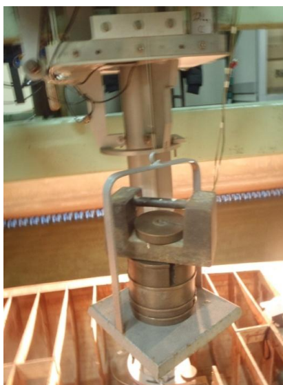
Σχ. 6-9 Βάρη που κρεμάστηκαν για την βαθμονόμηση του Side Force
