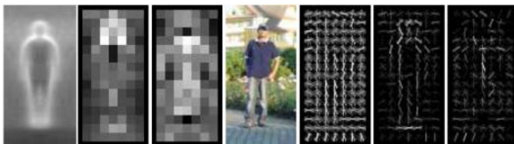
Σχήμα 4.2: Απεικόνιση ανθρώπου και υπολογισμών της προσανατολισμένης κλίσης συνολικά, αλλά και στα διαφορετικά κελιά για την εξαγωγή των HOG όπως στο σχήμα του [71].
