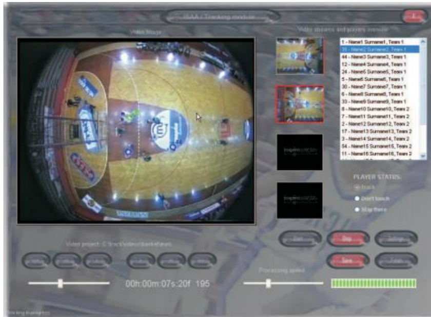
Σχήμα 2.2: Διεπαφή χρήστη ενός συστήματος sport play analysis [1]. Τρεις παίκτες έχουν εντοπιστεί, και το σύστημα εστιάζει στον παίκτη της δεξιάς πλευράς.
