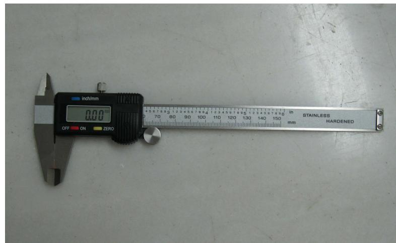
Εικόνα 4.5: Το παχύμετρο που χρησιμοποιήθηκε για την διαστατολόγηση των πλαστελινών
