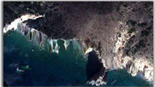
Εικόνα 4.29 Τραβηγμένες περιοχές λόγω εσφαλμένου ΨΜΕ στην αριστερή εικόνα του νότιου τμήματος
