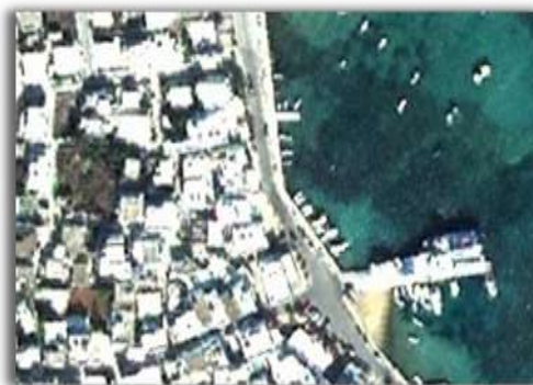
Εικόνα 4.12 Τμήμα της έγχρωμης εικόνας εξόδου χωρικής ανάλυσης 0,50 m, μετά από τη συγχώνευση
