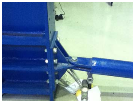
Σχήμα 4.17: Σύνδεση αξονικά καταπονούμενων μελών
