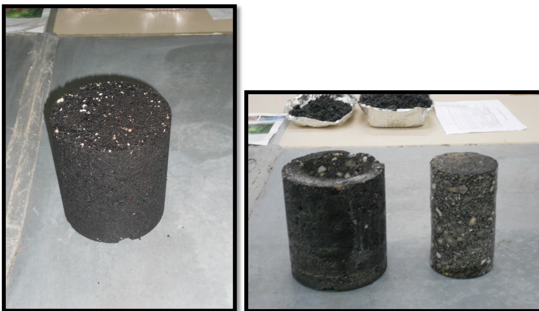
Εικόνα 5.2. Μορφή δοκιμίου από τη γυροσκοπική μέθοδο και μορφή δοκιμίου μετά την απόσπαση καρτόου από το εσωτερικό του.
