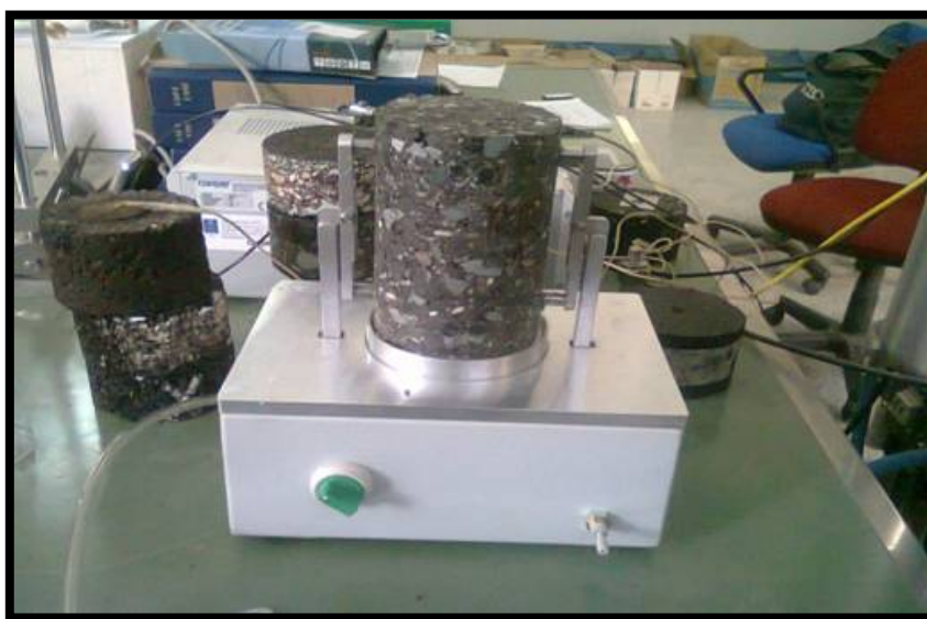
Εικόνα 6.2. Ειδική συσκευή προσάρτησης μεταλλικών βάσεων στο δοκίμιο
