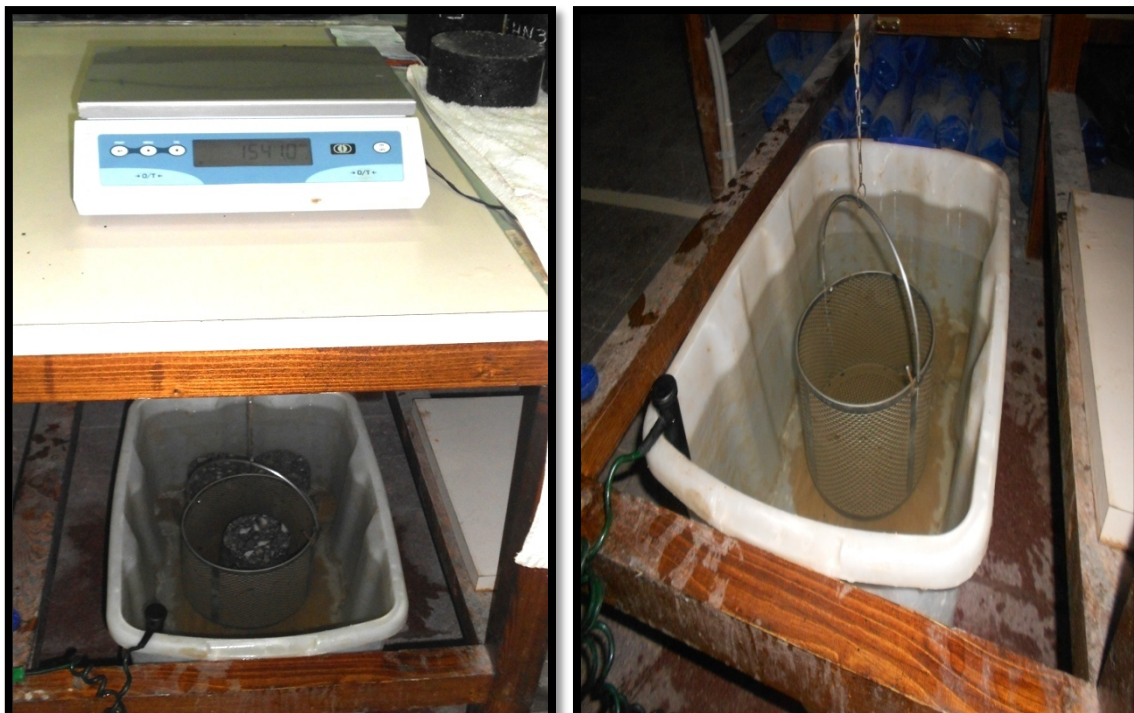
Εικόνα 6.1. Πειραματική διάταξη υδρόλουτρου
