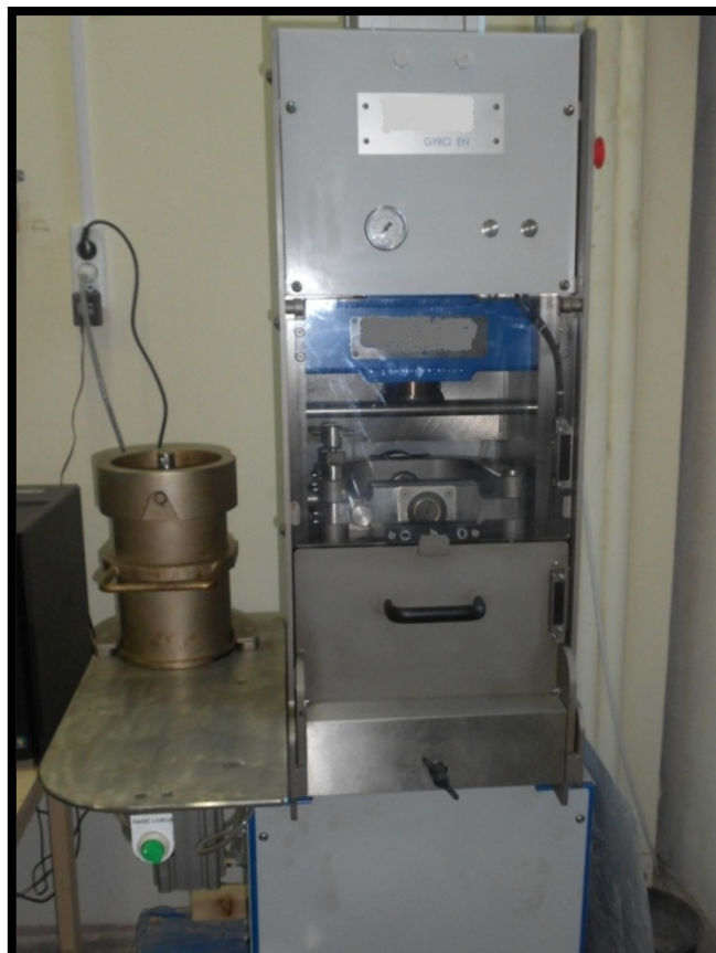
Εικόνα 5.1. Γυροσκοπικός συμπιεστής (Gyratory Compactor)
