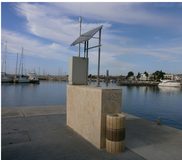
Εικόνα 2.8: Σύγχρονος ηλεκτρονικός παλιρροιογράφος σε προβλήτα λιμανιού.
