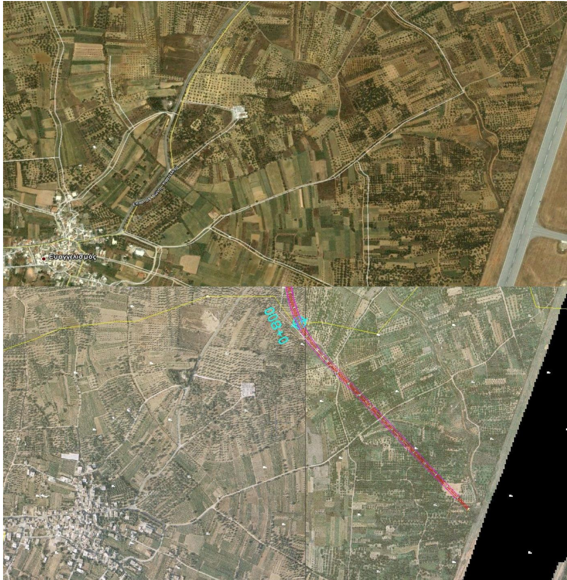
Φωτογραφία 4-4 : (Άνω) Δορυφορική φωτογραφία – (Κάτω) Αεροφωτογραφία στην οποία έχουν εισαχθεί οι ισοϋψείς (γραμμές κίτρινου χρώματος) και η οριζοντιογραφία της, υπό μελέτη, οδού (γραμμές κόκκινου χρώματος), καθώς και τα πρηνή ορυγμάτων (γραμμές μοβ χρώματος) και επιχωμάτων (γραμμές πράσινου χρώματος) αυτής.
