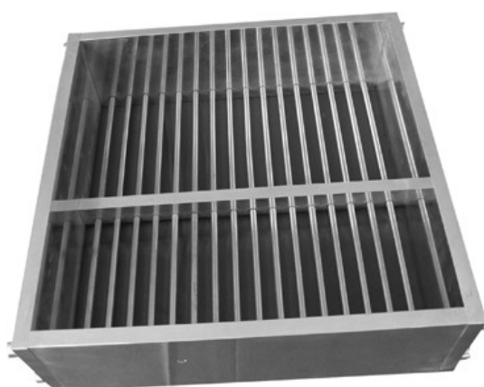
Εικόνα 2.8: Κόσκινο για πλακοειδείς κόκκους (σάρα)
