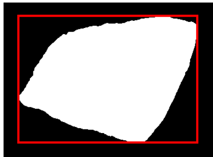
Εικόνα 3.19: Ελάχιστο δυνατό περιγεγραμμένο ορθογώνιο για μέτρηση πλάτους
