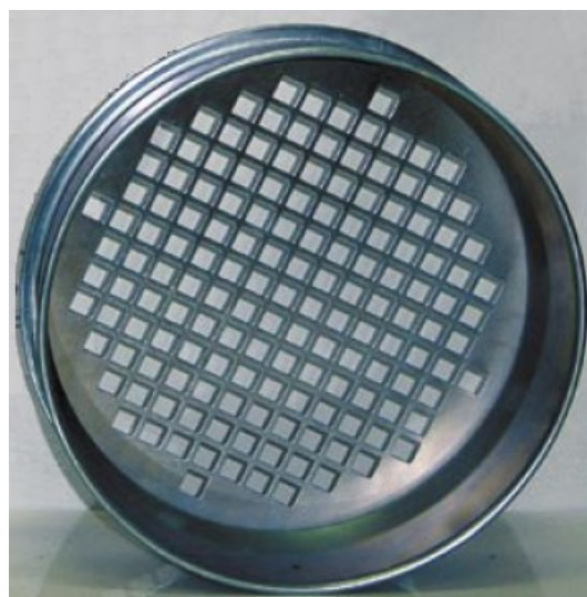
Εικόνα 2.3: Κόσκινο EN με διάτρητη πλάκα
