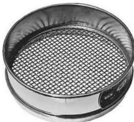
Εικόνα 2.4 : Κόσκινο ASTM με μεταλλικό πλέγμα
