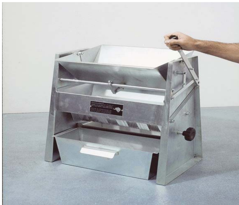
Εικόνα 2.2: Τετραμεριστήρας μεταβλητών ανοιγμάτων
