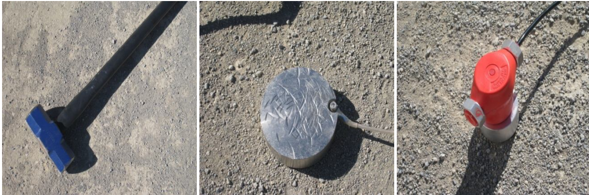
Εικόνα 4.1: Σφυρί, μεταλλική πλάκα, γεώφωνο
