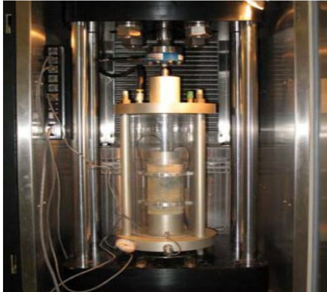
Εικόνα 2.1: Πειραματική διάταξη της δοκιμής για τον προσδιορισμό του M_R (resilient modulus test)
