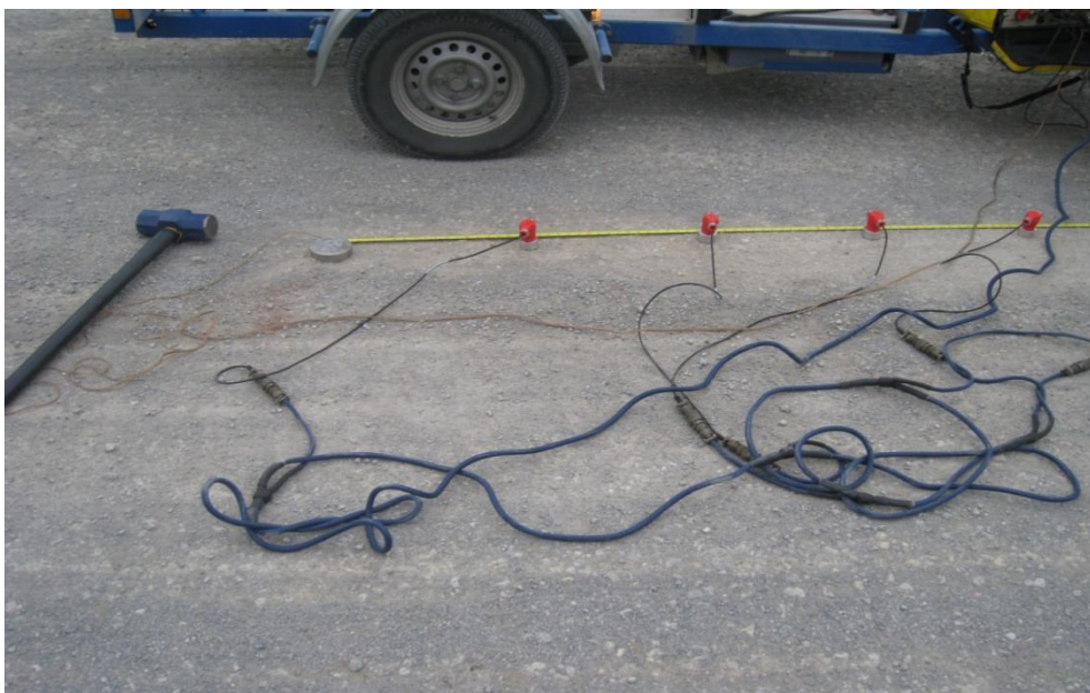
Εικόνα 5.11: Τοποθέτηση πηγής – δεκτών ανά 45 cm
