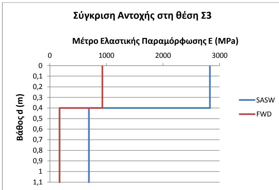
Σχήμα 7.27: Σύγκριση αντοχής κατά SASW, FWD στο Σ3
