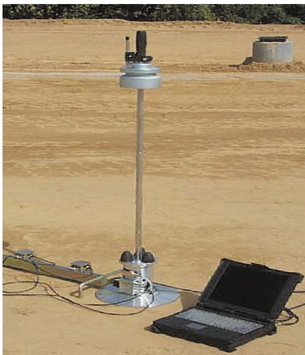
Εικόνα 2.4: Παραμορφωσίμετρο πίπτοντος ελαφρού βάρους LFWD (Nazzal, 2003)
