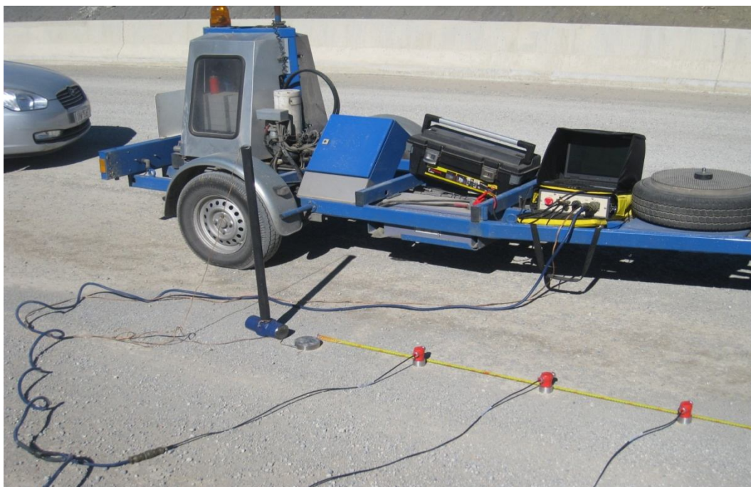
Εικόνα 5.7: Τοποθέτηση πηγής – δεκτών ανά 50 cm
