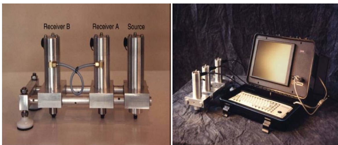
Εικόνα 4.4: Φορητός σεισμικός αναλυτής οδοστρωμάτων PSPA (Nazarian et al., 2005)
