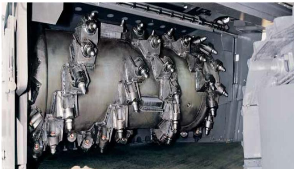
Εικόνα 10. Μορφή κοπτικού τυμπάνου Surface Miner (Manual Wirtgen GmbH, 2010).
