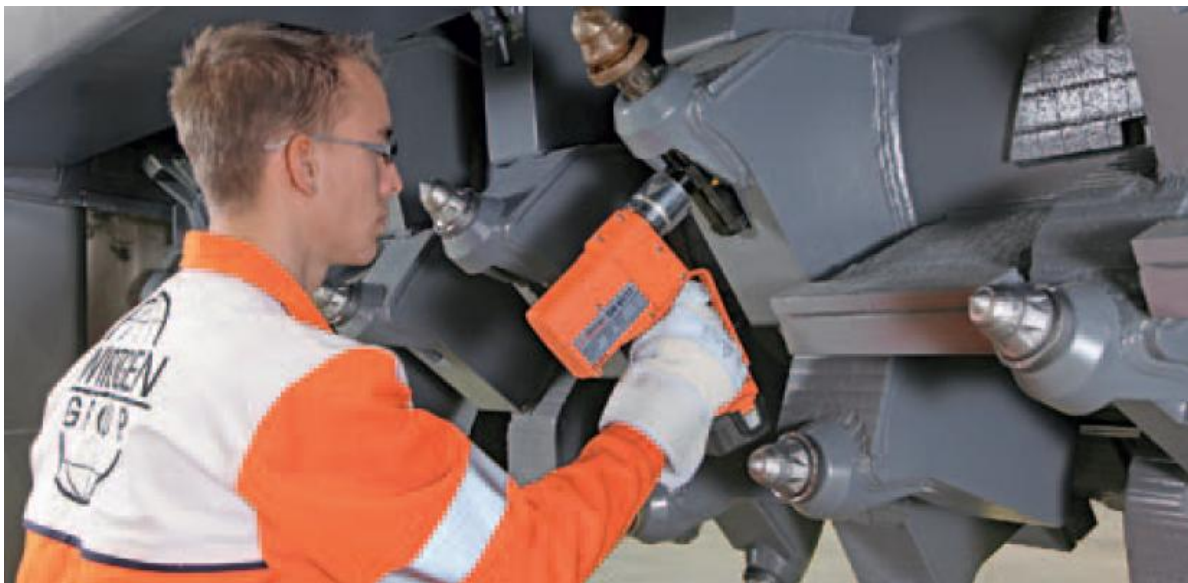
Εικόνα 11. Αλλαγή κοπτικού άκρου (Manual Wirtgen GmbH, 2010).
