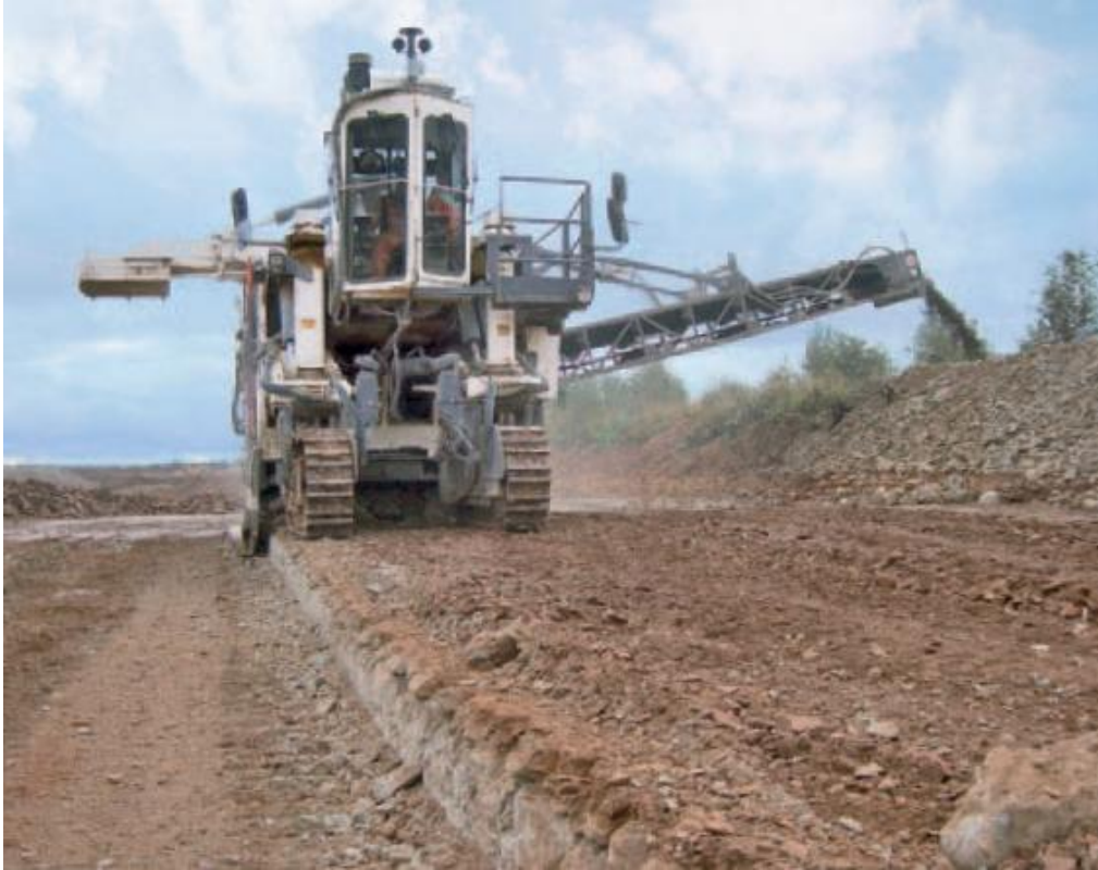
Εικόνα 16. Εναπόθεση του υλικού πλευρικά του Surface Miner (Manual Wirtgen GmbH, 2010).
