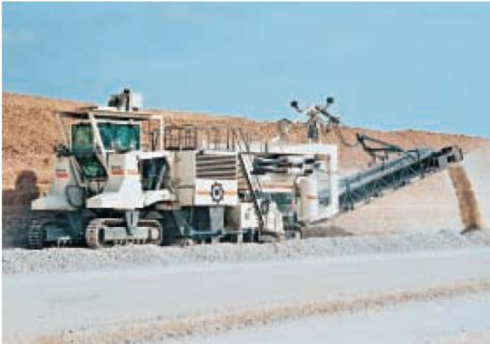
Εικόνα 15. Εναπόθεση του υλικού πίσω από το Surface Miner (Manual Wirtgen GmbH, 2010).
