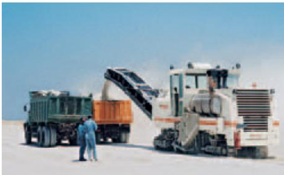
Εικόνα 14. Φόρτωση του εξορυγμένου υλικού μπροστά από το Surface Miner (Manual Wirtgen Gmbh, 2010).
