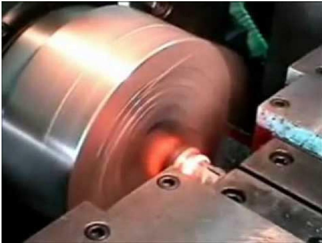
Εικόνα 7: Μηχανουργική κατεργασία για τη δημιουργία σπειρώματος. Η αναπόφευκτη απώλεια μαρτενσίτη δεν πρέπει να οδηγεί σε μείωση της αντοχής της ράβδου
