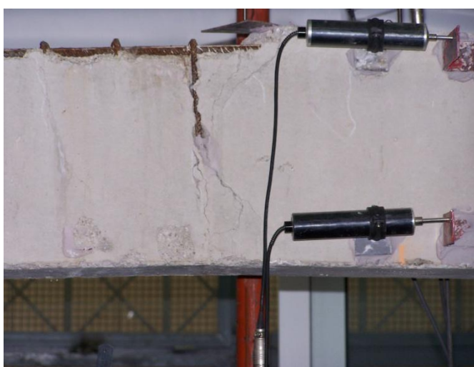
Εικόνα 18: Λεπτομέρεια αστοχίας ματίσματος στα δοκίμια L30D1 και L30D2 αντίστοιχα. Στη δεξιά εικόνα διακρίνεται εγκάρσια καμπτική ρωγμή στη μεσαία διατομή
