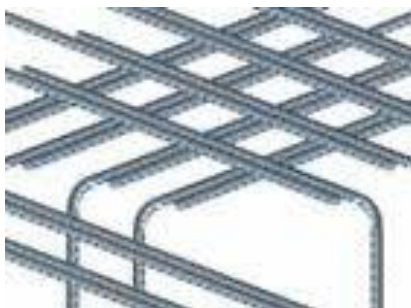
Εικόνα 2: Ένωση ράβδων οπλισμού με υπερέκλυση και με μηχανικά μέσα Αποφυγή «συνωστισμού» οπλισμών μέσω εφαρμογής ενώσεων με μηχανικά μέσα
