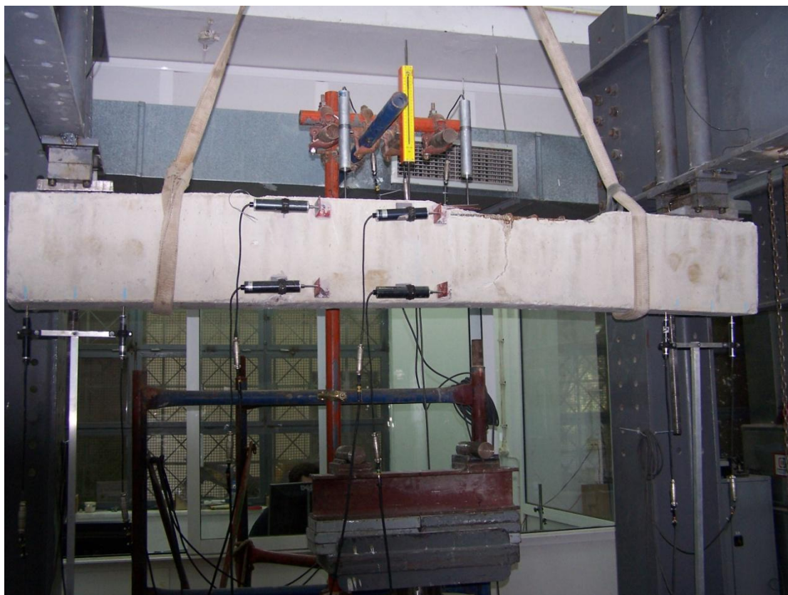
Εικόνα 17: Δοκίμιο τύπου L30D αμέσως μετά την αστοχία υπό μονοτονική φόρτιση
