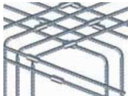
Εικόνα 2: Ένωση ράβδων οπλισμού με υπερέκλυση και με μηχανικά μέσα Αποφυγή «συνωστισμού» οπλισμών μέσω εφαρμογής ενώσεων με μηχανικά μέσα
