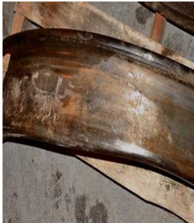
α) Πλαστική παραμόρφωση στην επιφάνεια κύλισης του τροχού
