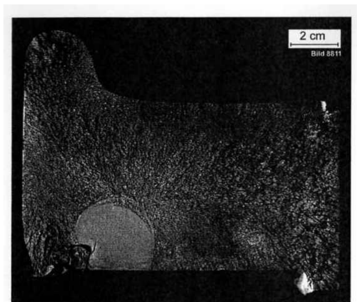
Εικόνα 2.19: Ανοιγμένη οπή, ρηγμάτωση επισώτρου [6]
