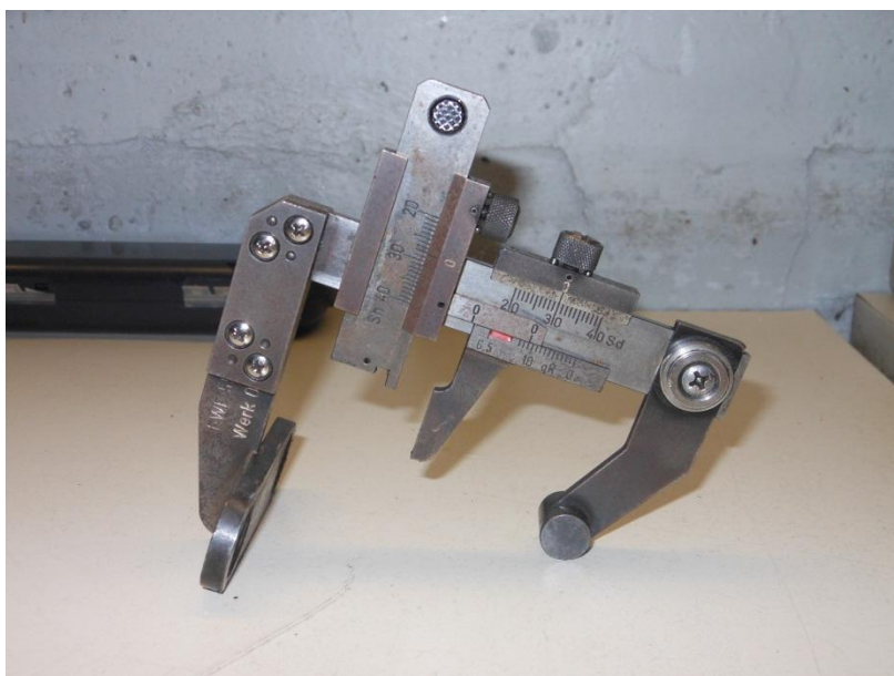
Εικόνα 4.5: Όργανο μέτρησης των παραμέτρων φθοράς
