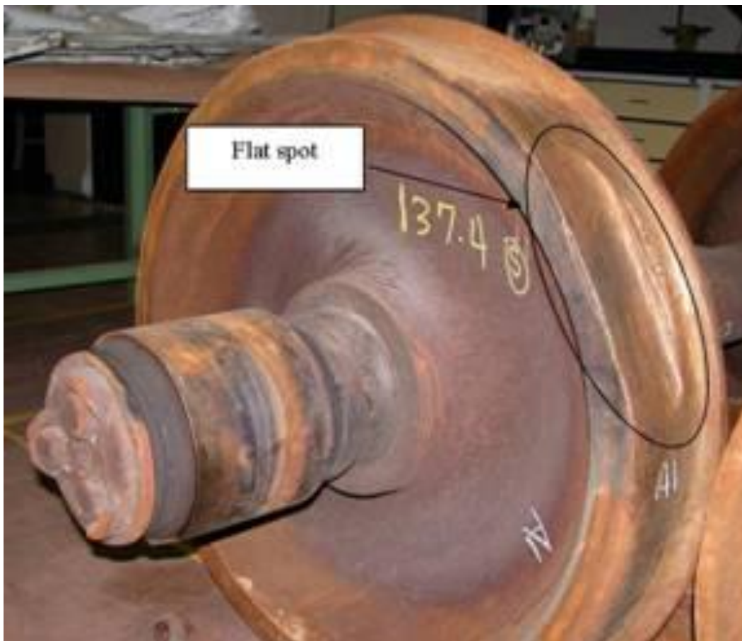
Εικόνα 2.10: Τροχοί με επιπεδότητα στο πέλαμα [7]
