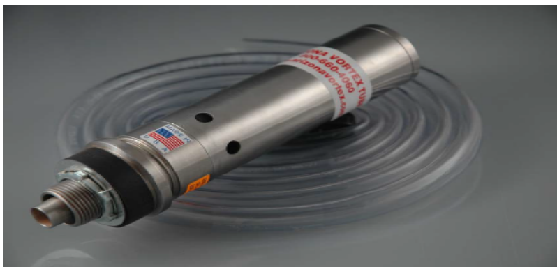
Εικόνα 1.8: Σωλήνας vortex με λάστιχο που ενσωματώνεται στην ψυχρή έξοδο για ψύξη σε εργαλειομηχανές CNC (Arizona Vortex Company).
