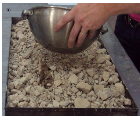
Εικόνα 4.5(α): Ανάμειξη υλικού με νερό
