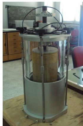
Εικόνα 4.9(β): Τοποθέτηση δοκιμίου στην κυψέλη
