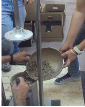
Εικόνα 4.7(α): Εισαγωγή δόσεων υλικού Εικόνα 4.7(β): Συμπύκνωση υλικού
