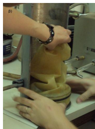
Εικόνα 4.6(β): Μembrάνη προστασίας δοκιμίου
