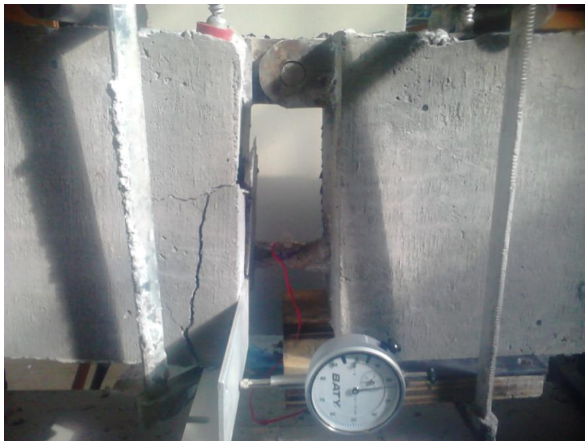
Σχήμα 3-14: Αστοχία δοκού (ράβδος 16mm)
