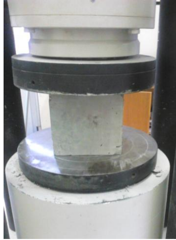
Σχήμα 3-6: Δοκιμή θλίψης κυβικού δοκιμίου
