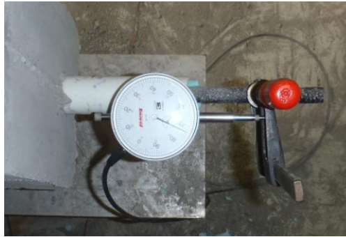
Σχήμα 3-12: Τα βελόμετρα τοποθετημένα στο δοκίμιο
