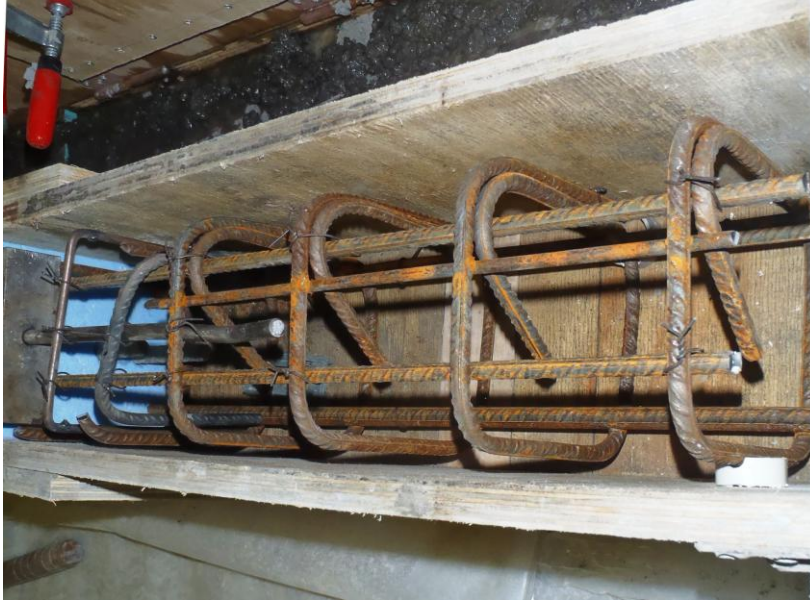
Σχήμα 3-2: Οι συνδετήρες του δοκιμίου
