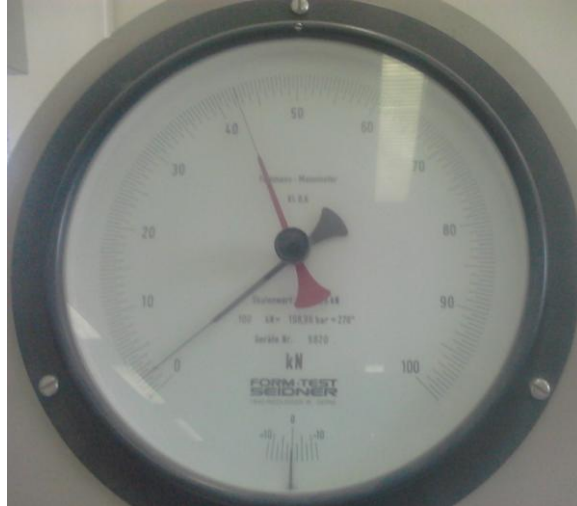
Σχήμα 3-8: Σύστημα ανάγνωσης επιβαλλόμενου φορτίου
