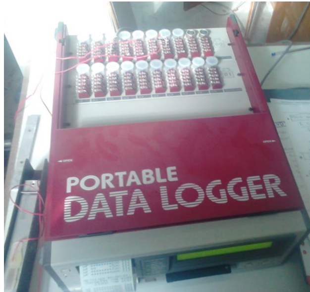
Σχήμα 3-10: Σύστημα καταγραφής μετρήσεων των ηλεκτρομηκυσιομέτρων
