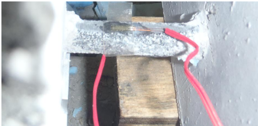
Σχήμα 3-9: Τα ηλεκτρομηκυνσιόμετρα επικολλημένα στη ράβδο
