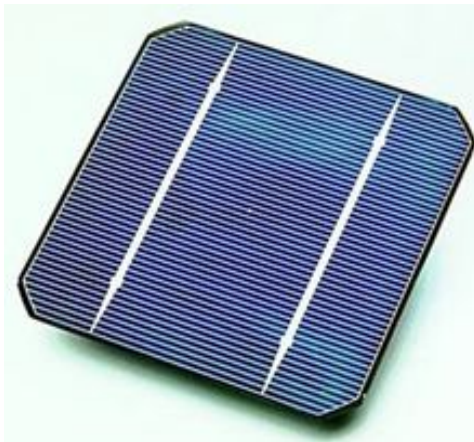
Εικόνα 1-3: Αριστερά: Ηλιακό στοιχείο, Δεξιά: Φωτοβολταϊκή συστοιχία
