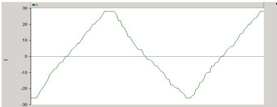
Γράφημα 6-14: Κυματομορφή ρεύματος αντιστροφέα SolarStar a6000
