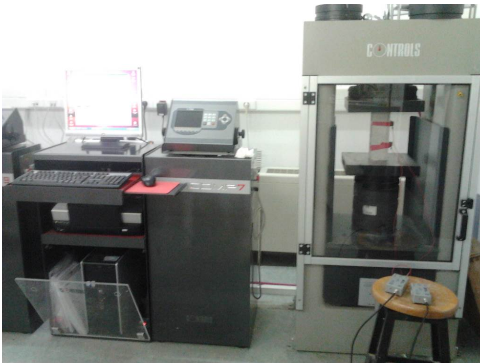
Εικόνα 3-22. Τοποθέτηση του πρίσματος στο πλαίσιο φόρτισης δυναμικότητας 5000 kN πριν την έναρξη της φόρτισης.
