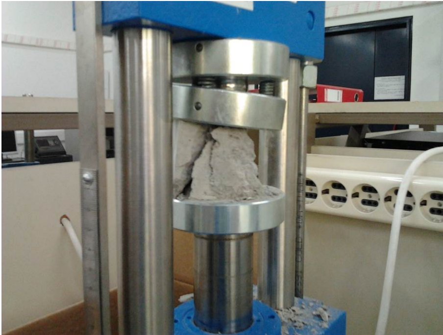
Εικόνα 3-16. Το δοκίμιο στο χειροκίνητο πλαίσιο φόρτισης πριν την έναρξη της δοκιμής μονοαξονικής θλίψης.
