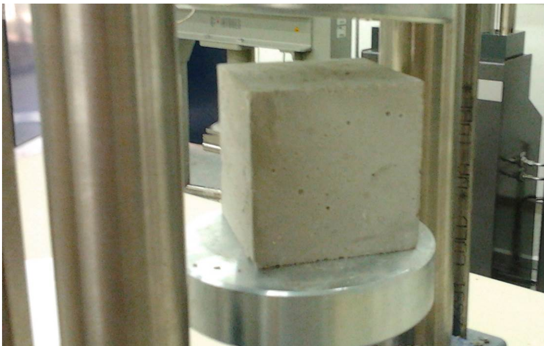
Εικόνα 3-11. Το δοκίμιο στο χειροκίνητο πλαίσιο φόρτισης πριν την έναρξη της δοκιμής μονοαξονικής θλίψης.
