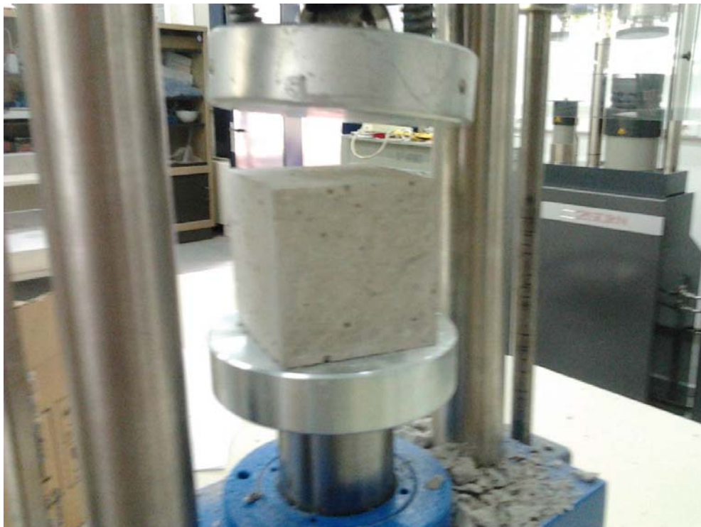
Εικόνα 3-13. Το δοκίμιο στο χειροκίνητο πλαίσιο φόρτισης πριν την έναρξη της δοκιμής μονοαξονικής θλίψης.
