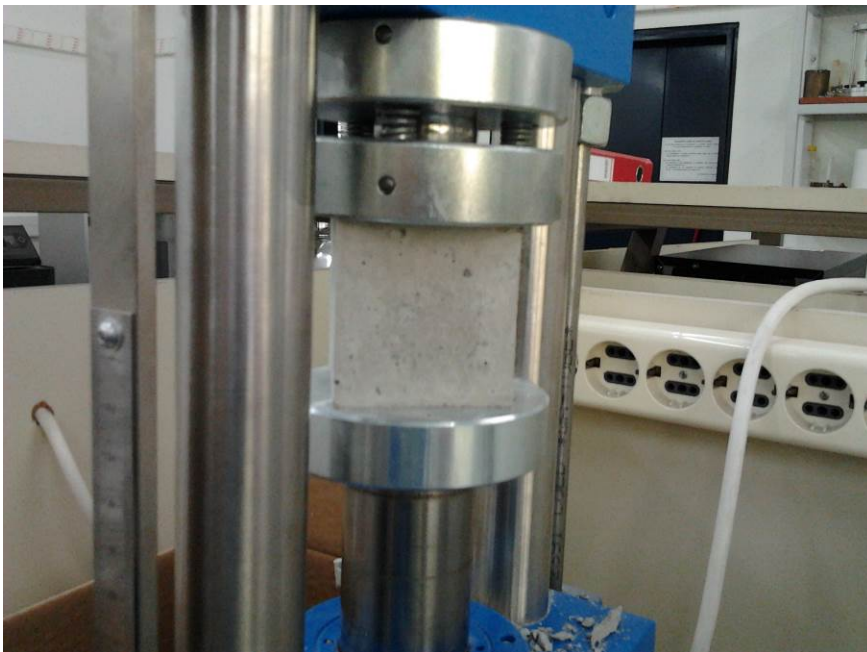
Εικόνα 3-15. Το δοκίμιο στο χειροκίνητο πλαίσιο φόρτισης πριν την έναρξη της δοκιμής μονοαξονικής θλίψης.
