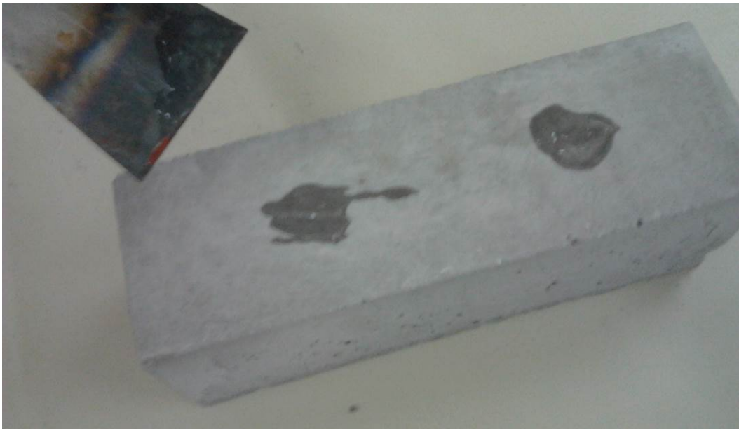
Εικόνα 3-19. Τοποθέτηση τζελ στο πρίσμα για τη βελτίωση της επαφής των αισθητήρων της ακουστικής εκπομπής με το υλικό.
