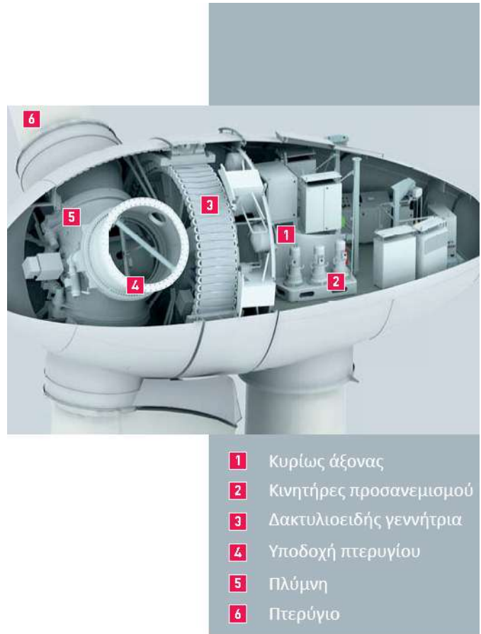
Εικόνα 34. Μέρη α/γ Enercon E-70
