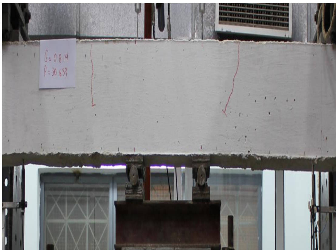
ΕΙΚΟΝΑ 24 Εμφάνιση της πρώτης οικογένειας ρωγμών ( καμπτικών ) στο δοκίμιο A4-M0
