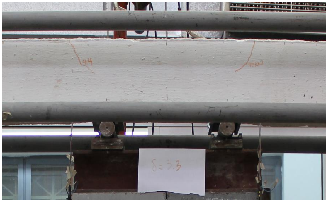
ΕΙΚΟΝΑ 44 Αύξηση του ύψους των ρωγμών της πρώτης οικογένειας
