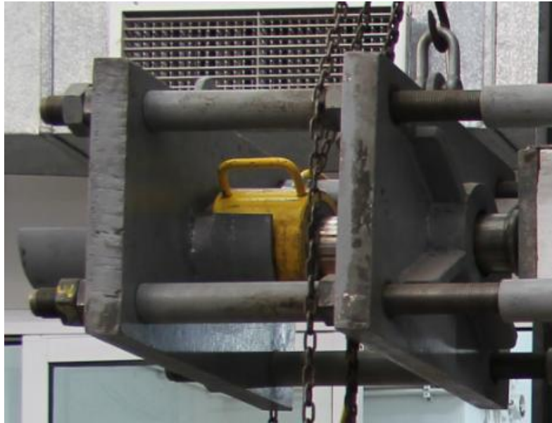
ΕΙΚΟΝΑ 8 Τοποθέτηση γρύλου στο δοκίμιο
