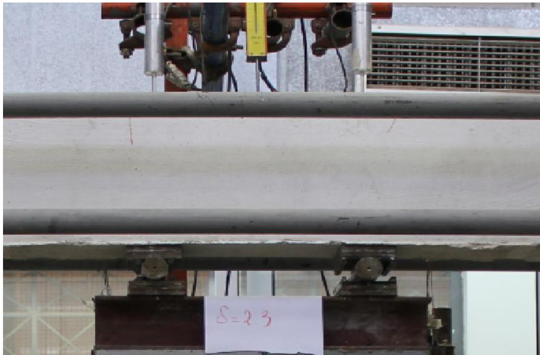
ΕΙΚΟΝΑ 16 Εμφάνιση της πρώτης οικογένειας ρωγμών ( καμπτικών ) στο δοκίμιο A2-M280
