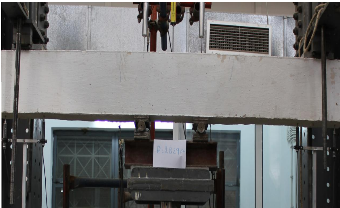
ΕΙΚΟΝΑ 11 Εμφάνιση της πρώτης οικογένειας ρωγμών (καμπτικών) στο δοκίμιο A1-M0
