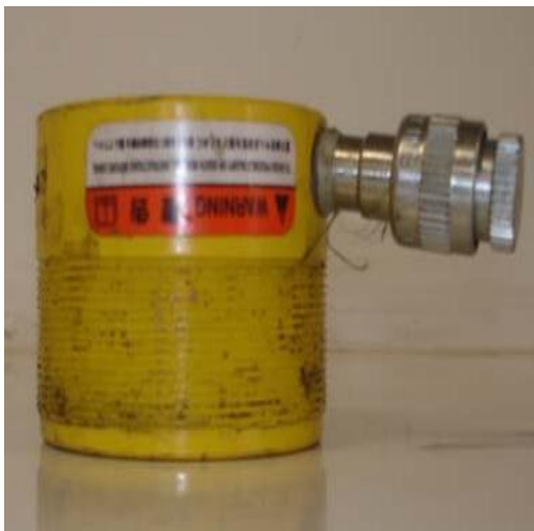
ΕΙΚΟΝΑ 7 Σύστημα επιβολής αξονικού φορτίου, υδραυλικός γρύλος
