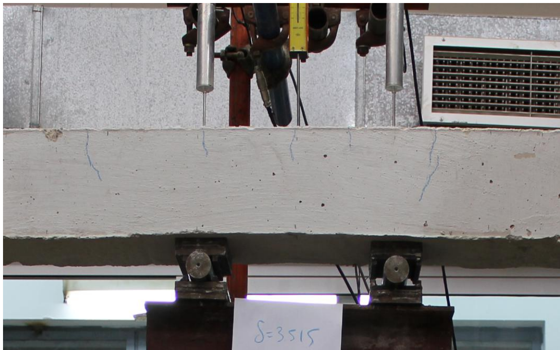
ΕΙΚΟΝΑ 51 Εμφάνιση νέας οικογένειας (καμπτικών) ρωγμών στη θέση της μέγιστης ροπής
