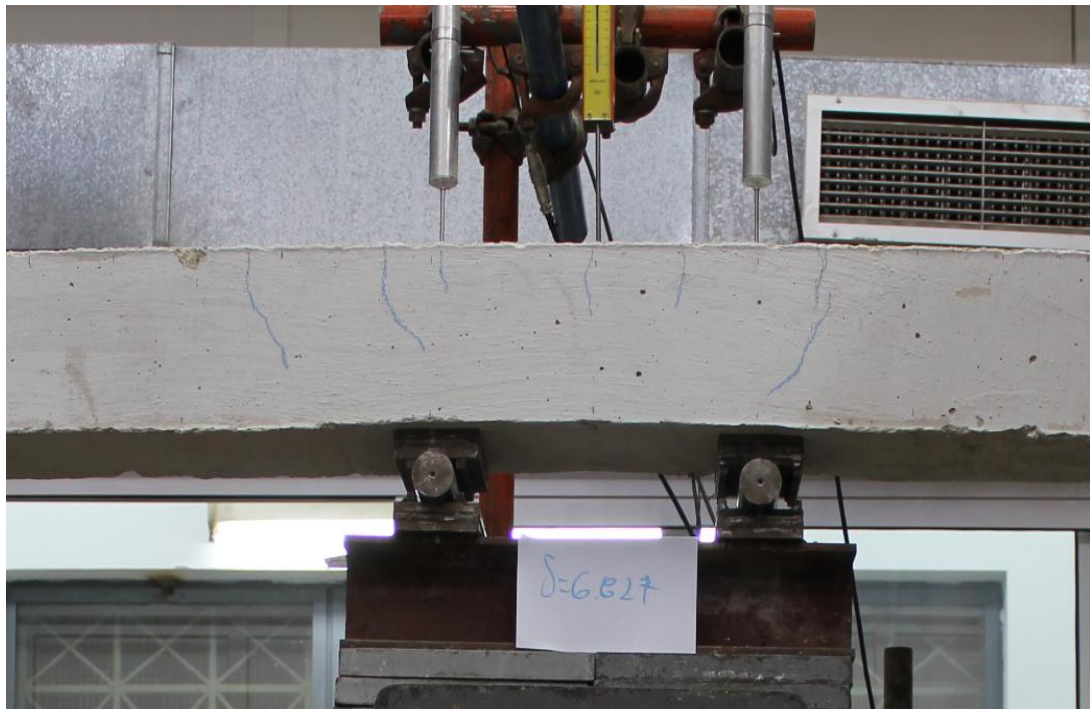
ΕΙΚΟΝΑ 52 Διαφοροποίηση του ύψους των ρωγμών και εμφάνιση μιας νέας (καμπτικής ρωγμής)
