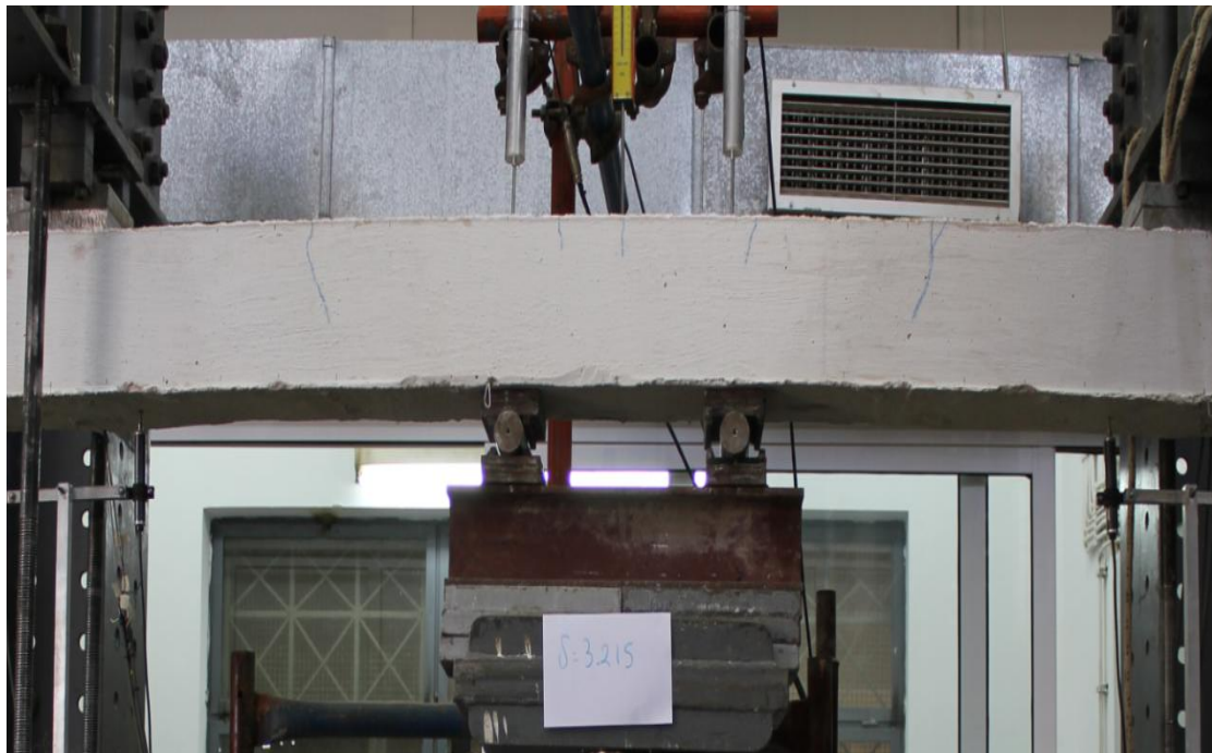
ΕΙΚΟΝΑ 30 Εμφάνιση της πρώτης οικογένειας ρωγμών B1-M0
