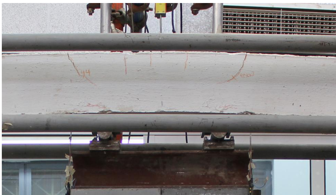
ΕΙΚΟΝΑ 46 Εμφάνιση νέας καμπτικής ρωγμής στη θέση της μέγιστης ροπής και μιας οριζόντιας ρωγμής
