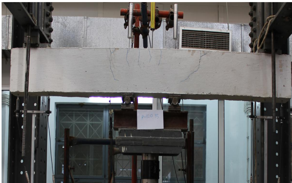
ΕΙΚΟΝΑ 13 Δημιουργία νέας οικογένειας ρωγμών και διαφοροποίηση του ύψους στις ρωγμές της πρώτης οικογένειας ( δοκίμιο A1-M0 )
