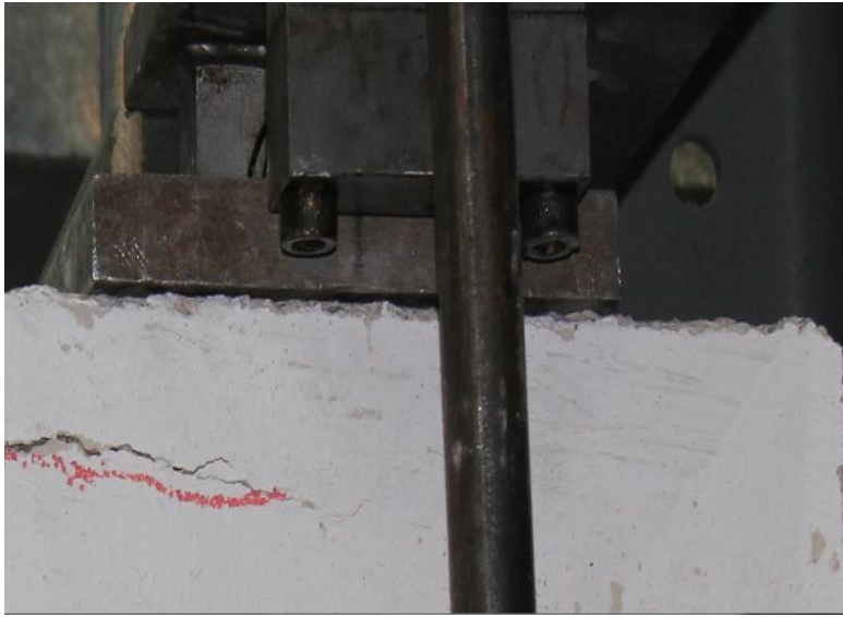
ΕΙΚΟΝΑ 3 Μεταλλικά δύσκαμπτη πλάκα
