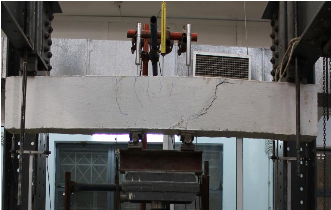
ΕΙΚΟΝΑ 14 Η φάση αστοχίας του δοκμίου Α1-Μ0
