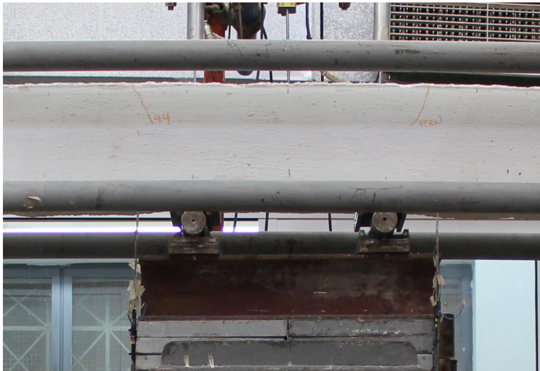
ΕΙΚΟΝΑ 43 Εμφάνιση καμπτικών ρωγμών – πρώτη οικογένεια ρωγμών
