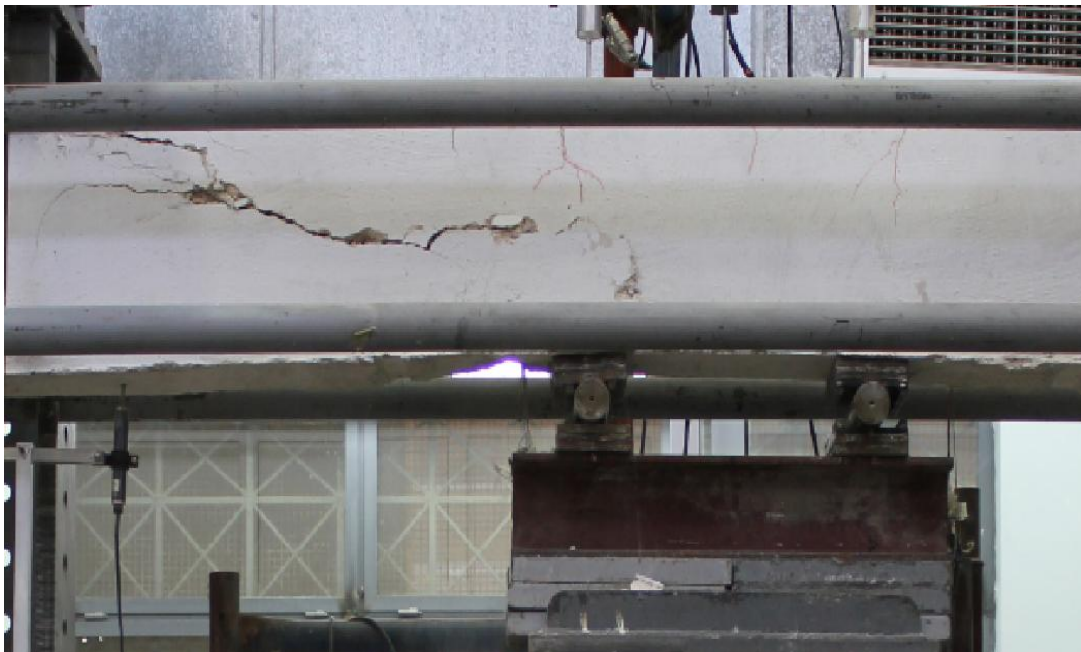
ΕΙΚΟΝΑ 21 Δημιουργία οριζόντιας ρωγμής από την οποία επέρχεται η αστοχία του δοκιμίου A2-M280
