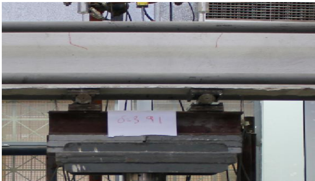
ΕΙΚΟΝΑ 17 Διαφοροποίηση ύψους της πρώτης οικογένειας ρωγμών στο δοκίμιο A2-M280
