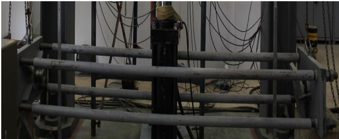
ΕΙΚΟΝΑ 9 Η διάταξη που περικλείει το δοκίμιο και βοηθάει στην επιβολής της αξονικής δύναμης.
