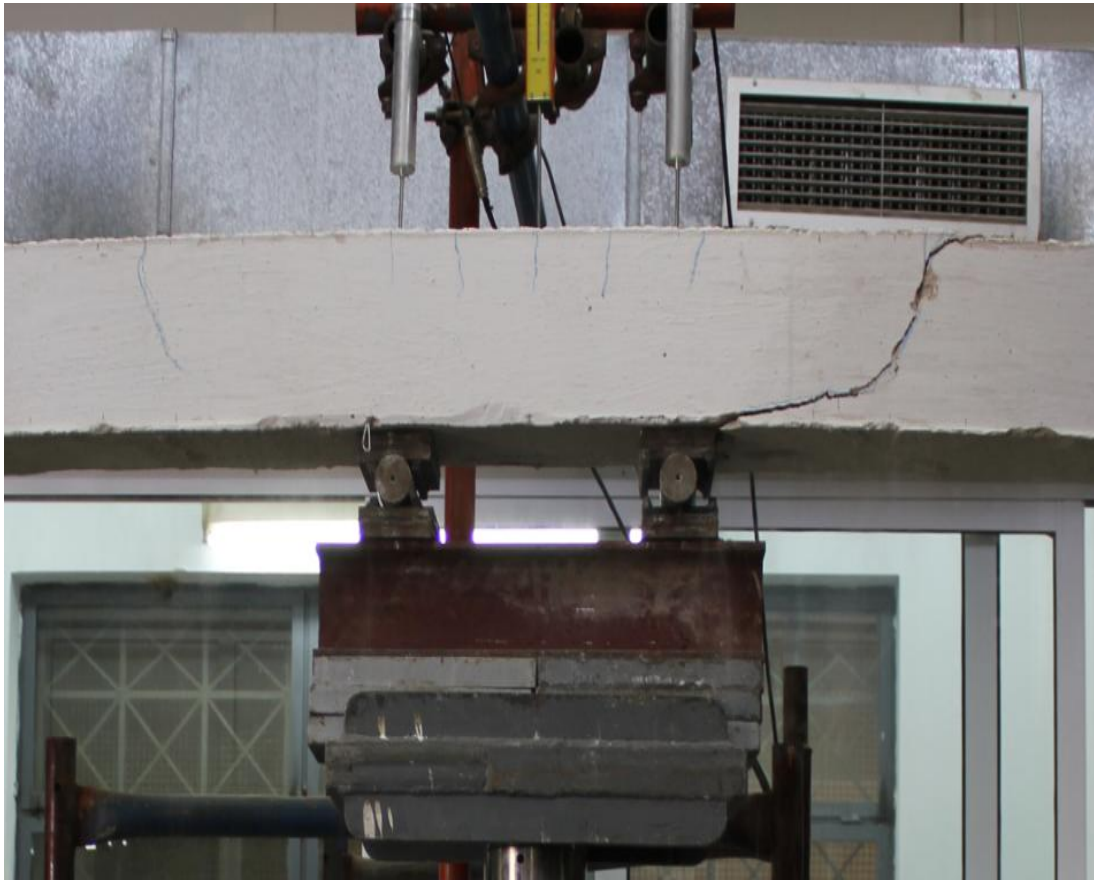
ΕΙΚΟΝΑ 32 Αστοχία του δοκμίου Β1-Μ0
