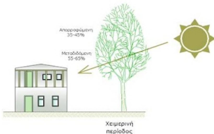
Εικ.2.2.4.2: Σκίαση νότιας όψης κτηρίου από φυλλοβόλο δέντρο τη θερινή περίοδο, χωρίς να παρεμποδίζεται σημαντικά ο ηλιασμός του τη χειμερινή περίοδο. (πηγή: «The Effect of Green Roofs on the Urban Climate. Case Study: Athens». MPhil Dissertation, Department of Architecture, University of Cambridge, 2001.)
