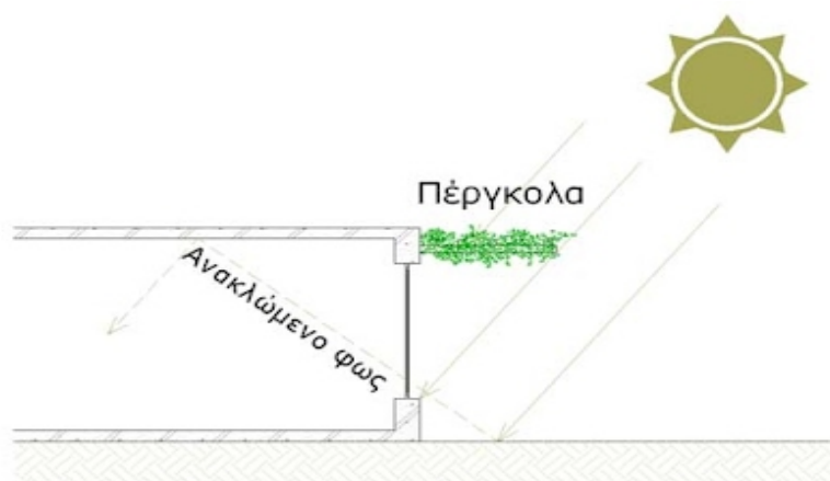
Εικ. 2.2.4.4: οριζόντιο σκίαστρο με πέργκολα με φυτά (πηγή: «The Effect of Green Roofs on the Urban Climate. Case Study: Athens». MPhil Dissertation, Department of Architecture, University of Cambridge, 2001.)
