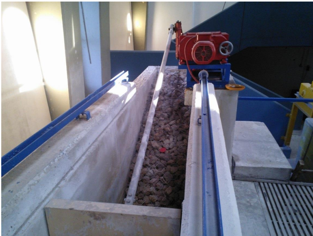
Φωτ. 6 – Το πρώτο άκρο της διώρυγας με την κυματογεννήτρια, έναν αποσβεστήρα κυματισμών και το περύγιο του κυματιστήρα.
