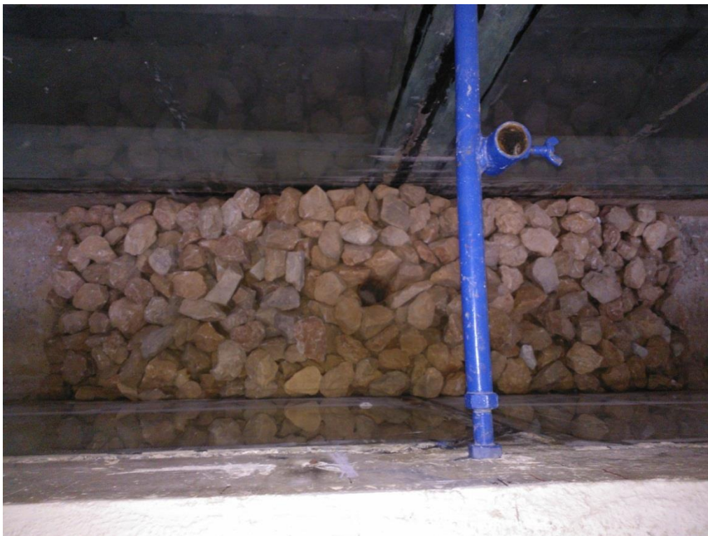
Φωτ. 4 – Ο ύφαλός κυματοθραύστης της πειραματικής διάρρυγας όπως φαίνεται κοιτώντας από πάνω.
