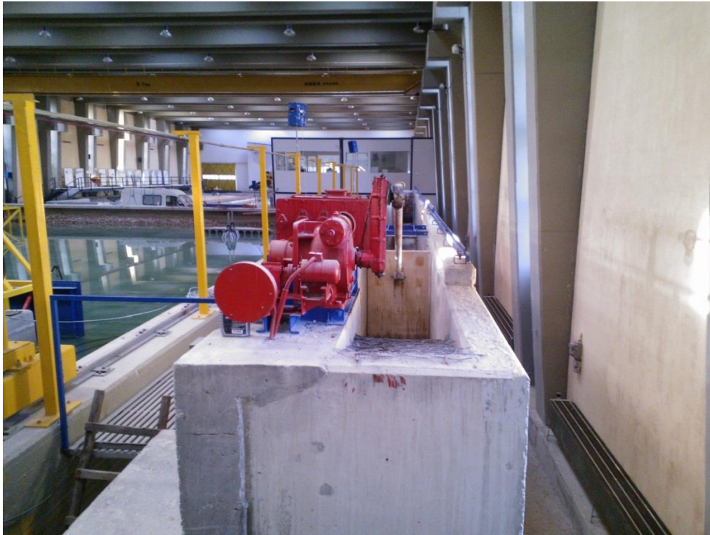
Φωτ. 1 – Η πειραματική διάρρυγα όπως φαίνεται κοιτώντας από την άκρη που βρίσκεται η κυματογεννήτρια (με κόκκινο χρώμα). Ευδιάκριτο είναι και το περύγιο του κυματιστήρα.
