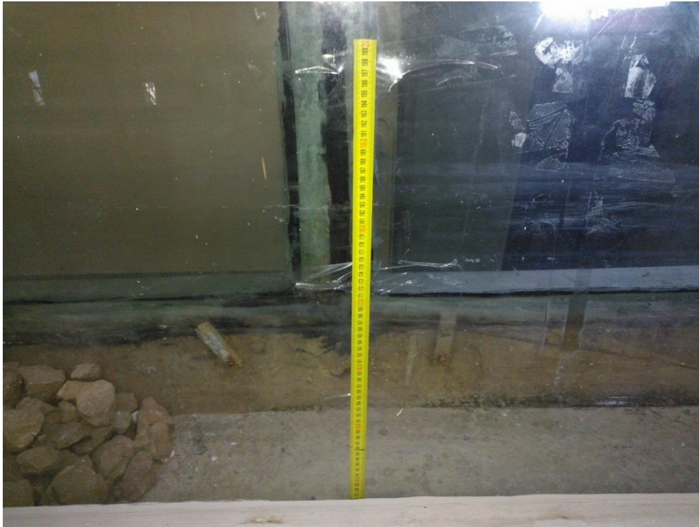
Φωτ. 3 – Βαθμονομημένος γνώμονας σε σημείο ανάντι του ύφαλου κυματοθραύστη για τη λήψη πειραματικών μετρήσεων (με οπτική παρατήρηση).
