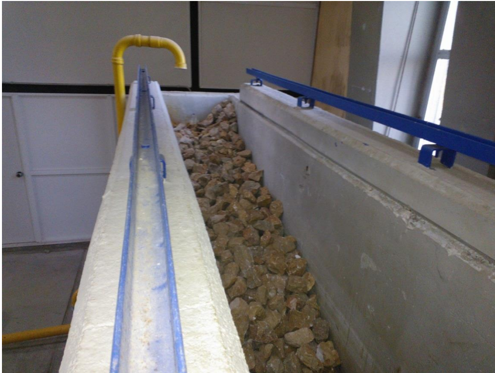
Φωτ. 5 – Το άλλο άκρο της πειραματικής διώρυγας. Εδώ φαίνεται ο αποσβεστήρας κυματικής ενέργειας που αποτελείται από λίθους και ένας κίτρινος σωλήνας από όπου γίνεται η είσοδος νερού στη διώρυγα.
