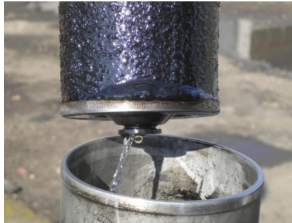
Σχήμα 3.6. Φραγμένο φίλτρο καυσίμου λεωφορείου λόγω μικροβιακής δραστηριότητας
