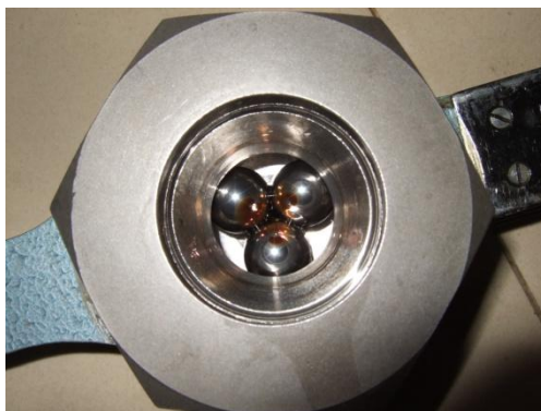
Σχήμα IV.9 Φθορά στις στατικές σφαίρες της τετράσφαιρου μετά το τέλος της δοκιμής αξιολόγησης των χαρακτηριστικών πρόληψης φθοράς (το εξεταζόμενο δείγμα έχει αφαιρεθεί)
