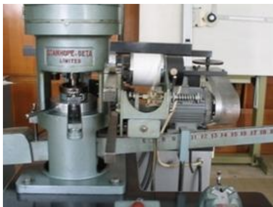
Σχήμα IV.8: Η τετράσφαιρος συσκευή
