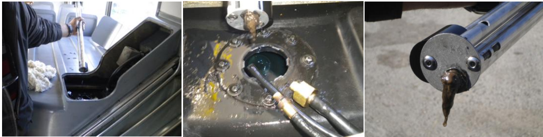
Σχήμα 3.5. Δείγματα του βιολογικού υλικού που είχε δημιουργηθεί στα ρεζερβουάρ των λεωφορείων
