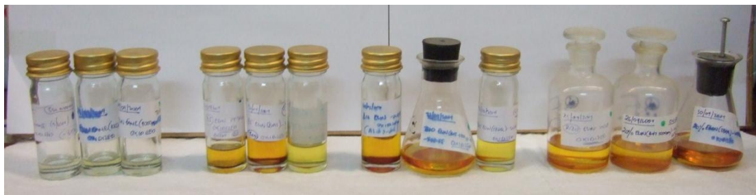
Σχήμα 2.33. Οξειδωμένα δείγματα του FAME1 και των B5-B20 μειγμάτων του
