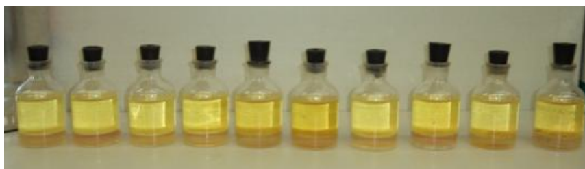
Σχήμα 3.24. Επιμολυσμένα δείγματα παρουσία αντιοξειδωτικού TBHQ 0.1%wt.
