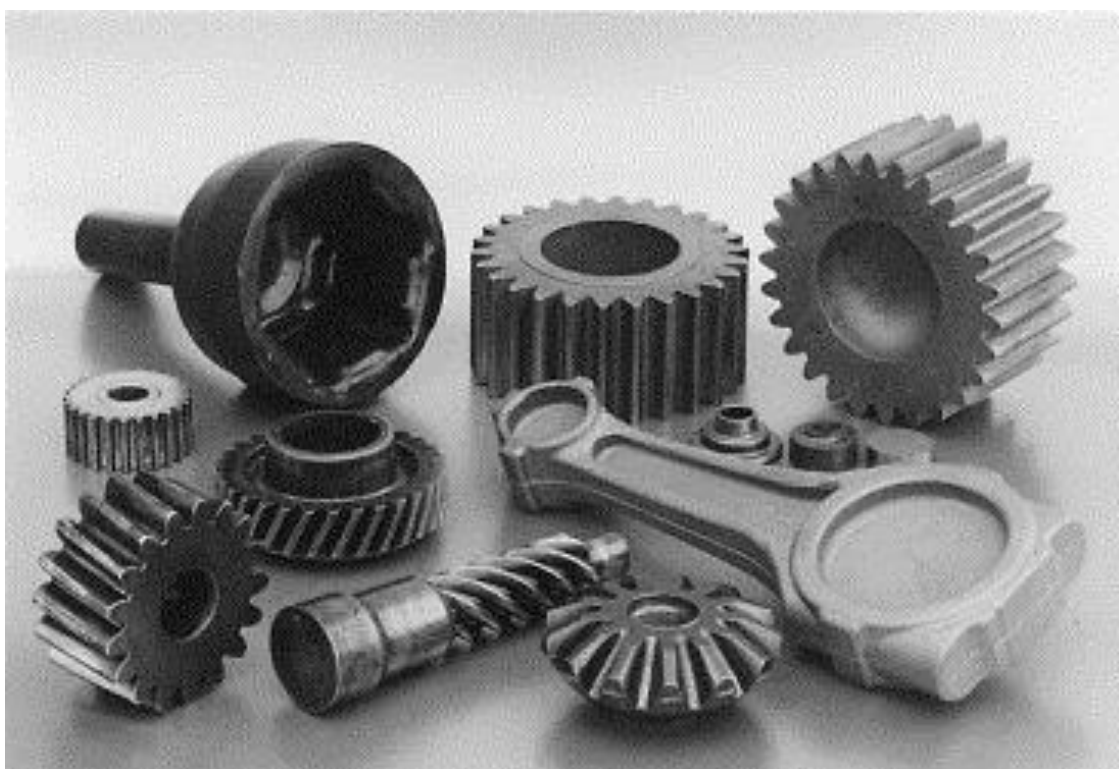
Σχήμα 1.7 Οδοντωτοί τροχοί και άλλα εξαρτήματα κατασκευασμένα με σφυρηλάτηση ακριβείας.
