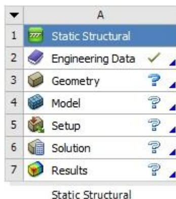
Σχήμα 5.1 Παράθυρο συστήματος Static Structural στο περιβάλλον Workbench.
